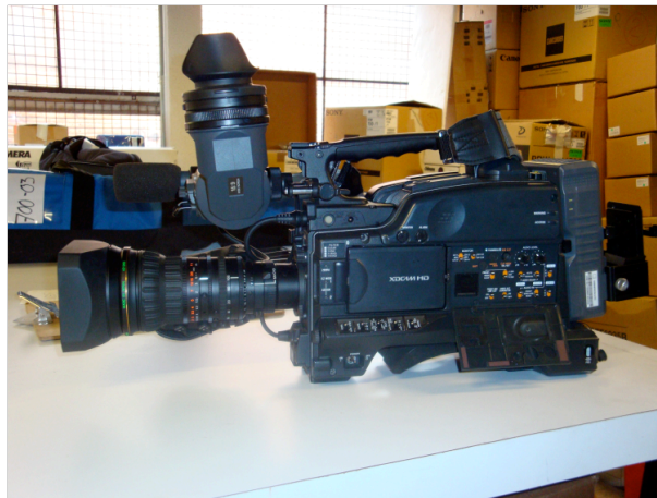
Figura 3-6. Cámara modelo PDW-F35 grabación en disco XDCAM de alta definición con una resolución de 1440X1080
