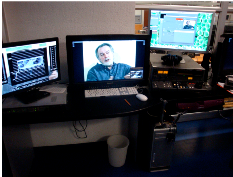
Figura 5-21. Terminal de ingesta compuesta por una computadora modelo Mac pro, una máquina Betacam SP (con convertidor de análogo a digital), rasterizador y monitor de imagen de 24 pulgadas.
