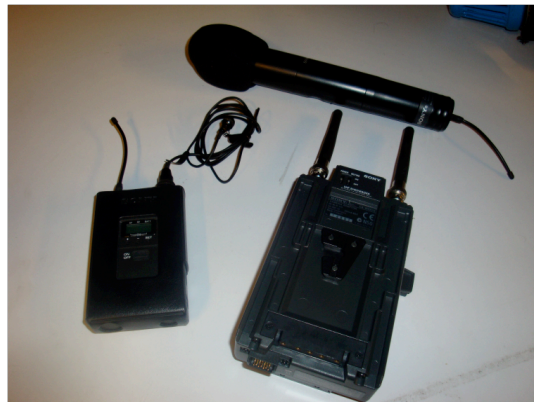
Figura 3-8. Los tipos de micrófono que se utilizan en un sistema portátil, a la derecha vemos un micrófono de maraca inalámbrico con su transmisor y a la izquierda un micrófono Lavalier.
