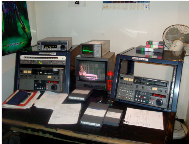
Figura 3-12. Isla de edición lineal en donde se observan las dos máquinas betacam SP, los monitores forma de onda y de imagen y su monitor de audio stereo.
