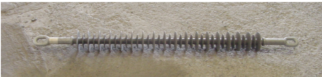
Figura 11. Aisladores de hule de silicón de suspensión
