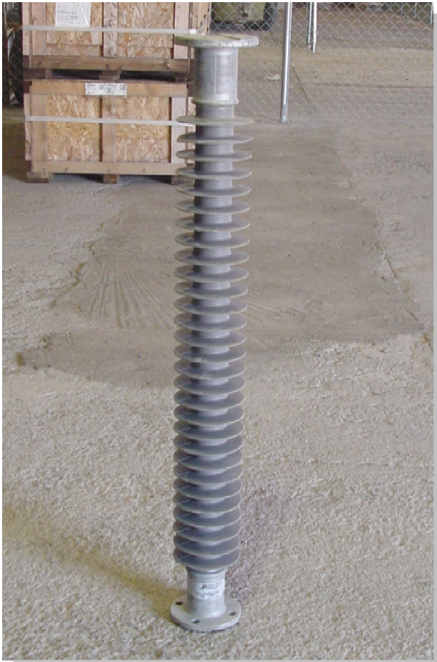
Figura 12. Aisladores de hule de silicón tipo poste o cantiliever
