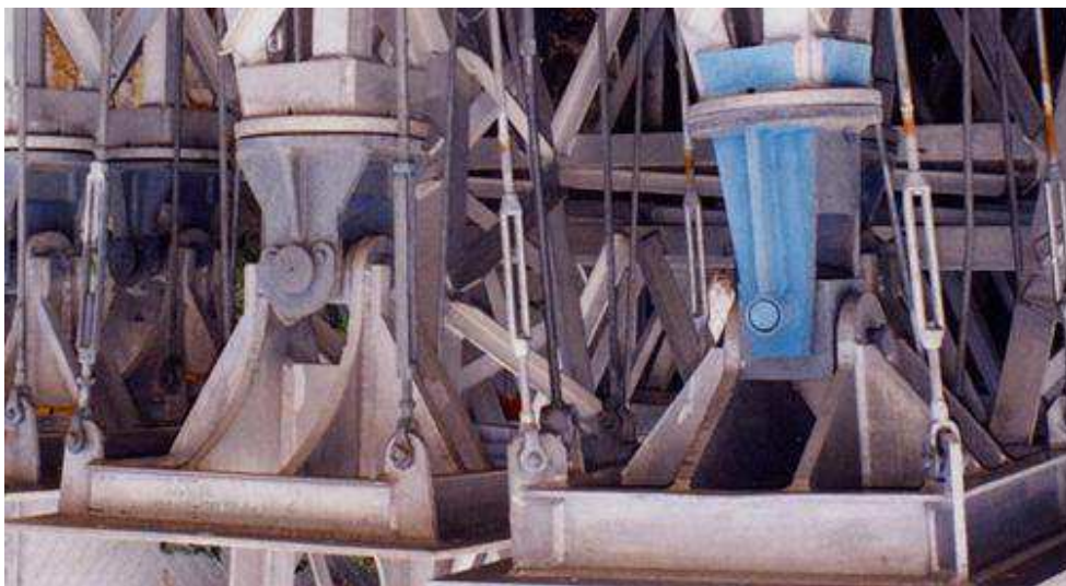
Figura 4. Diferencias en la articulación universal entre la marca lindsey (izquierda) y prinex (derecha)
