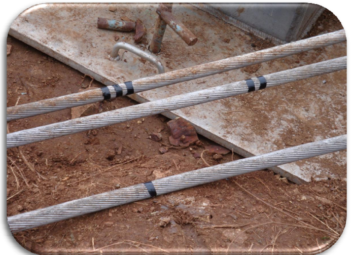
Figura 101. Disposición de conductores en piso de estructura colapsada e identificación de conductores de una de las fases
