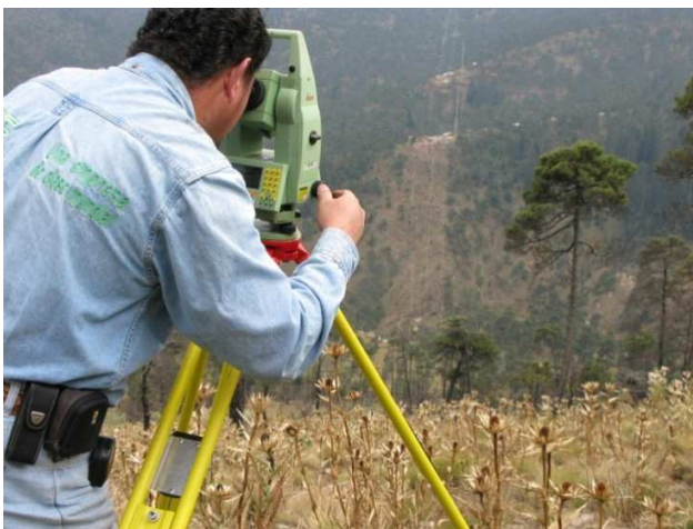
Figura 83. Obtención de perfiles longitudinales y contraperfiles del claro de estructura 49-50.
