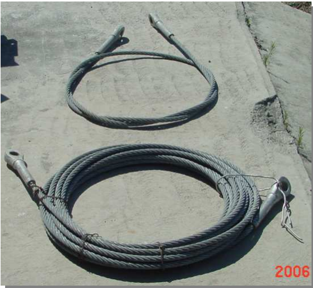
Figura 22. Cable de acero para unir dos columnas (violín ó top cross guy en ingles)
