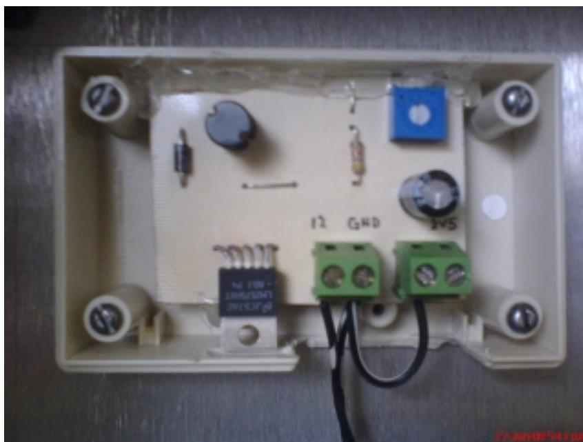
Figura 5.18. Circuito impreso ensamblado de la fuente de 2.56 V.
