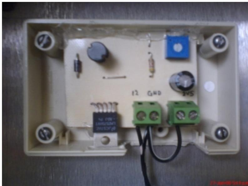
Figura 3.21. Implementación de la fuente variable de 2.5V.
