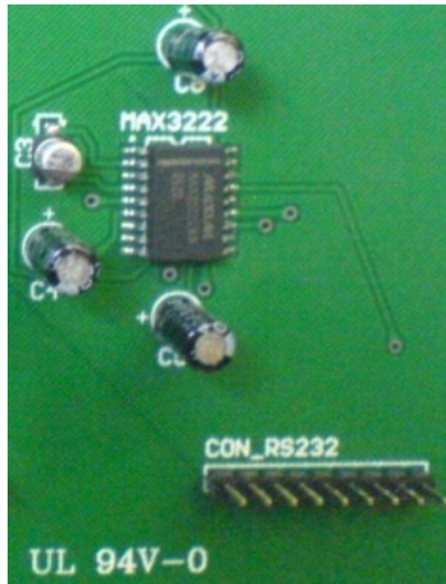
*Figura 3.32. Circuito integrado para el protocolo RS232.*
