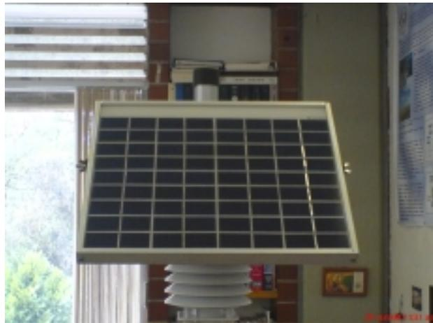
*Figura 3.16. Módulo de captación solar de la estación remota.*
