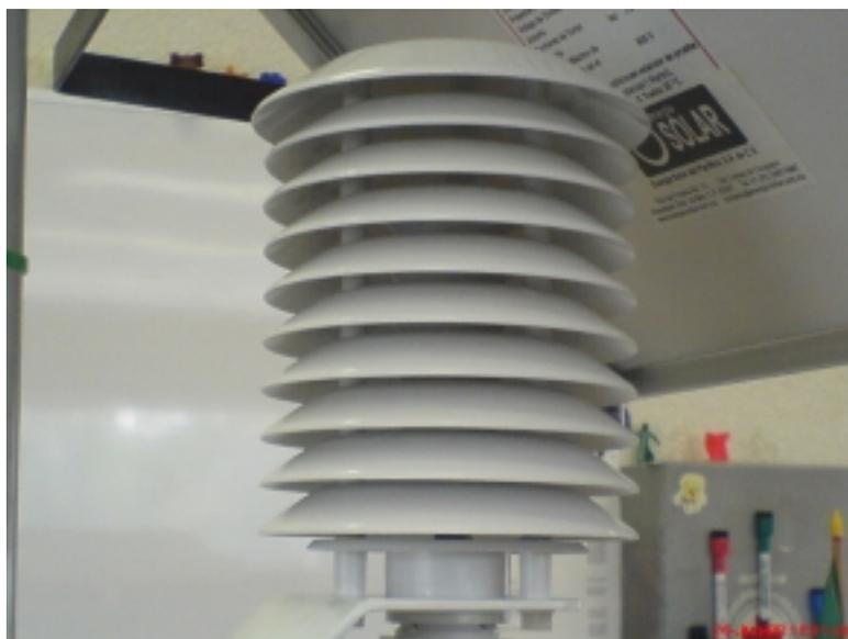
*Figura 3.39. Protector de radiación solar.*
