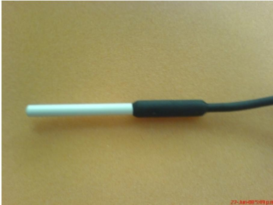
*Figura 3.38. Sonda de temperatura.*
