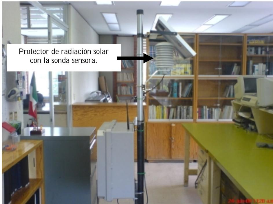
*Figura 3.41. Instalación en la estructura de la estación remota.*
