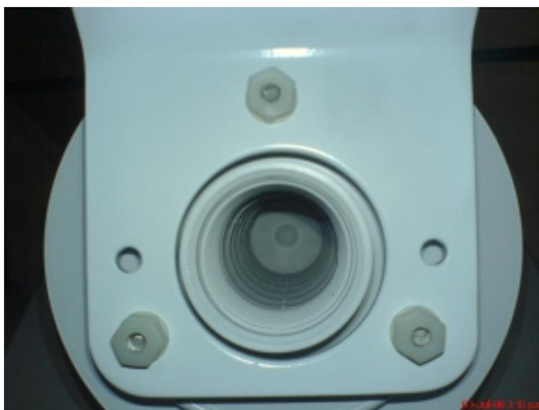
*Figura 3.40. Interior del protector de radiación solar.*
