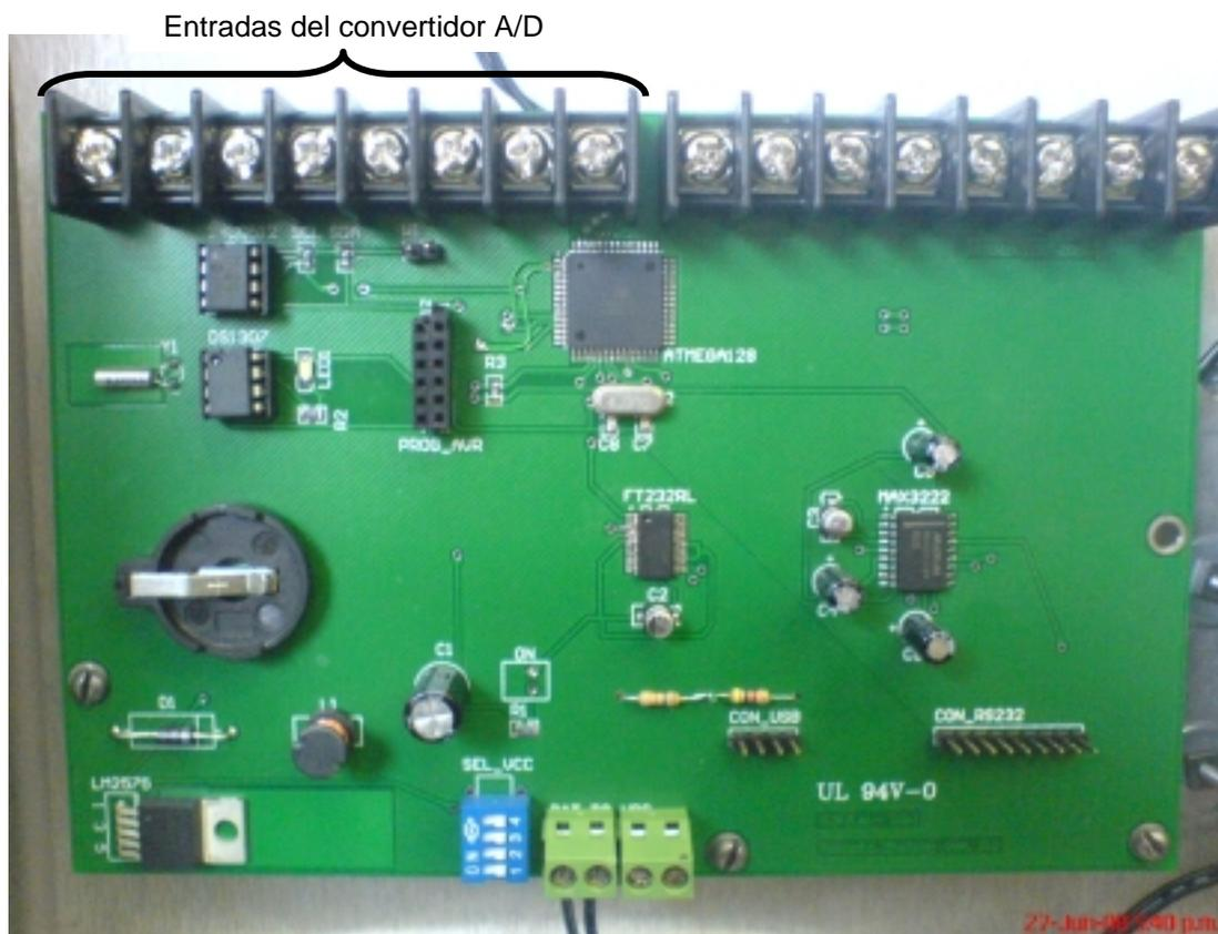
Figura 3.29. Entradas del convertidor A/D en la tarjeta principal.
