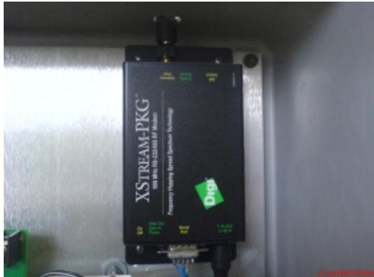
*Figura 3.35. Radio módem utilizado en la estación remota.*
