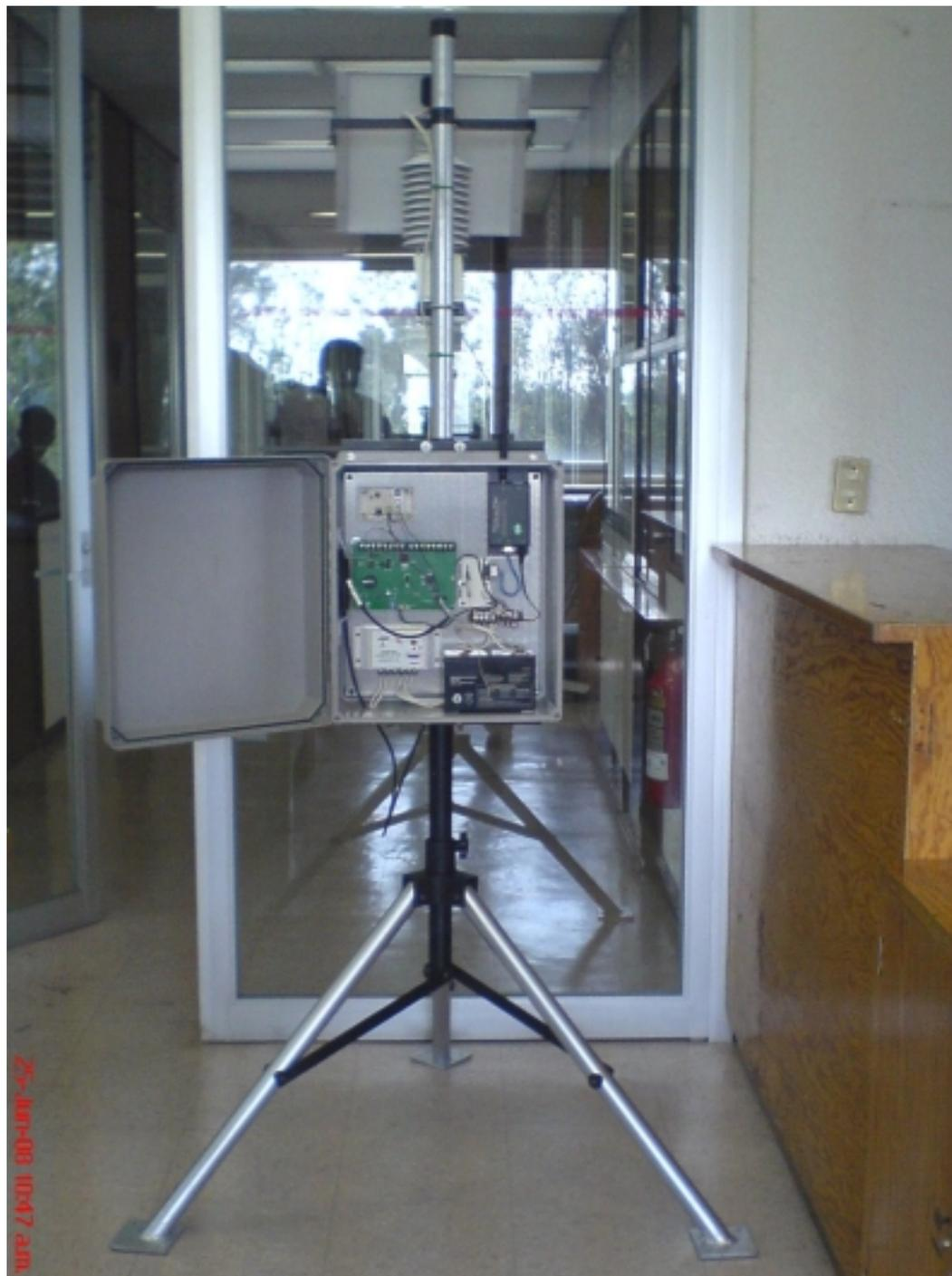
*Figura 5.20. Instalación de la tarjeta de circuito impreso dentro del gabinete de la estación remota.*
