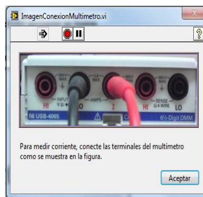
Figura A.3.2 Conexión para voltaje. Figura A.3.3 Conexión para corriente.
