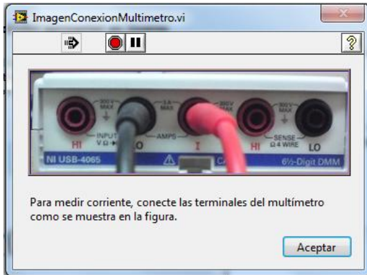
Figura 3.4-8. Conexión para medir corriente.
