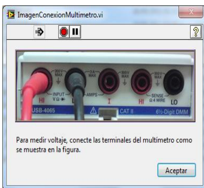
Figura A.3.2 Conexión para voltaje. Figura A.3.3 Conexión para corriente.
