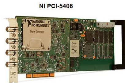
Figura 1.2-5. Tarjeta de National Instruments NI PCI-5406 Generador de Funciones.
