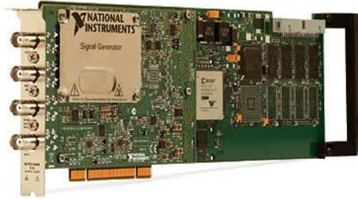
Figura A.1.1 Tarjeta PCI-5406 (Generador de funciones).
