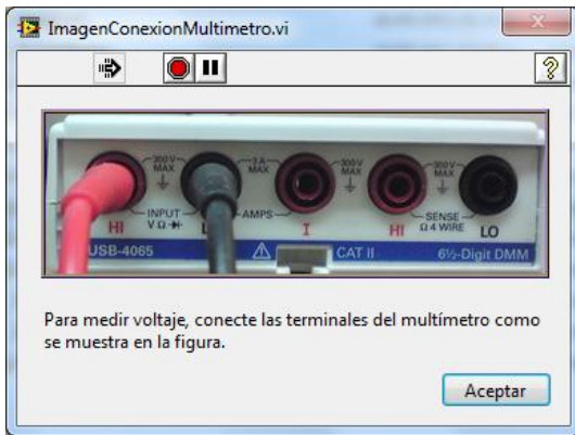
Figura 3.4-44. Conexión para medir voltaje.
