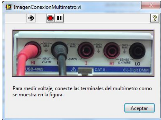
Figura 3.4-20. Conexión para medir voltaje.
