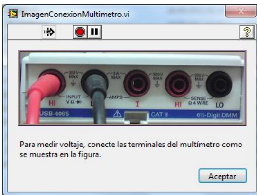
Figura 3.4-4. Conexión para medir voltaje.
