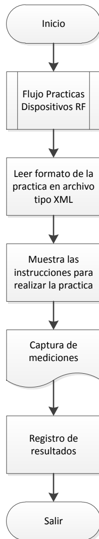
Figura 2.1-3. Diagrama de flujo de FlujoPracticaDispositivosRF.vi.
