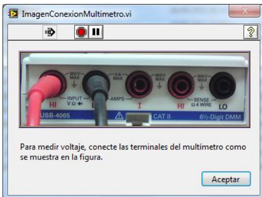
Figura 3.4-12. Conexión para medir voltaje.
