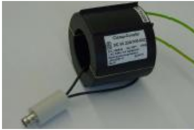
Fig. 2.3 Acoplador inductivo de baja TENSIÓN
