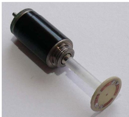
Figura 4.3: Elemento radiador acoplado a la flecha del motor con una extensión de polietileno.
