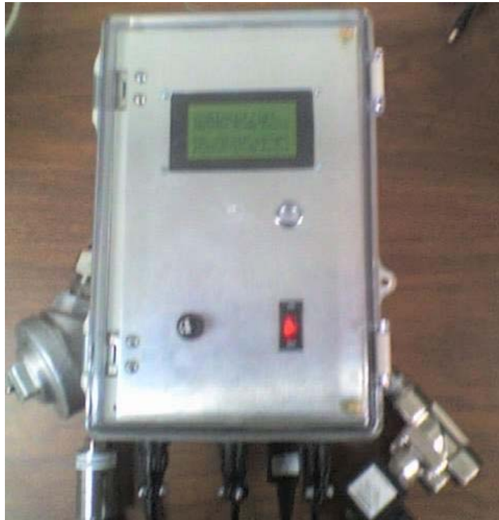
Figura 4.1. Medidor de incondensables.
