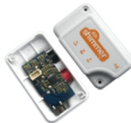
Figura 59. Sensor inalámbrico ECG Shimmer
