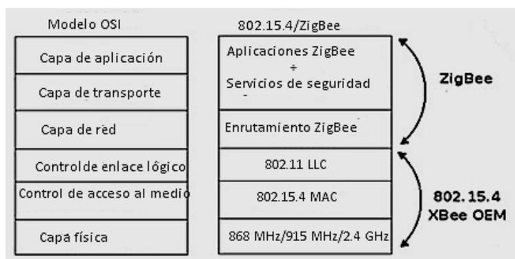
Figura 11. Comparación del modelo OSI con 802.15.4/ZigBee
