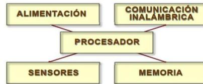
Figura 7. Arquitectura de un nodo inalámbrico
