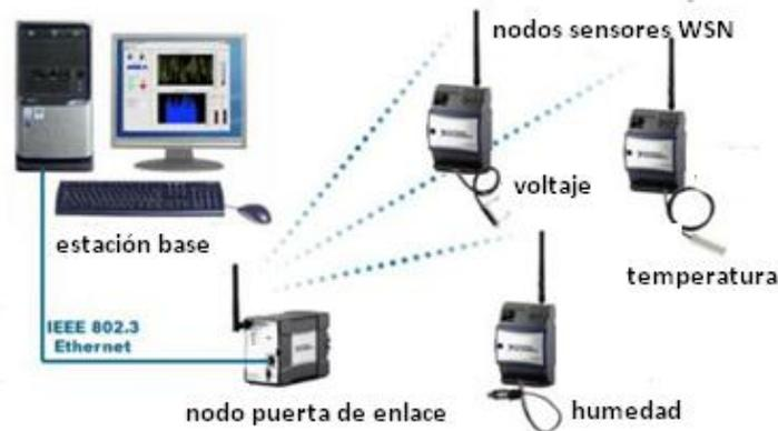
*Figura 5. Red inalámbrica de sensores*
