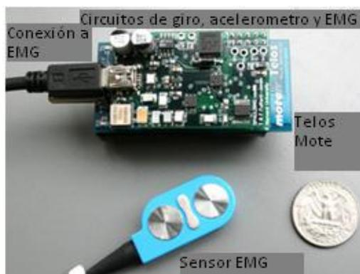
Figura 25. Sensor EMG y de movimiento
