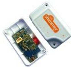
*Figura 61. Sensor inalámbrico EMG Shimmer*
