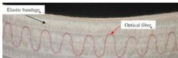
Figura 23. Fibra óptica dentro de un vendaje elástico
