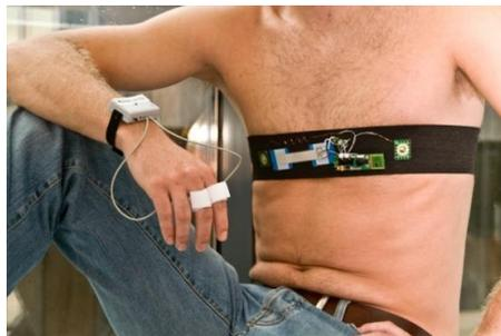
Figura 14. Ejemplo de montaje de los nodos sensores
