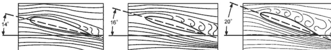
Figura 2.3: Flujo turbulento con diferentes ángulos de ataque
