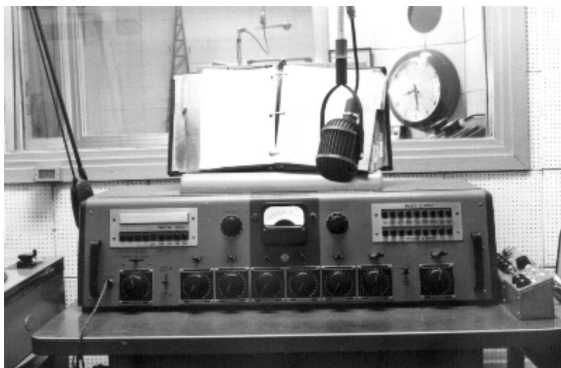
Figura 2. Consola de mezcla RCA 76-B5.
