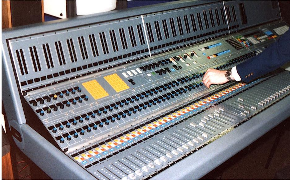
Figura 5. Primera consola de mezcla digital, la NEVE DSP1.
