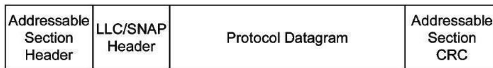
Encapsulación para los datagramas de diferentes protocolos
