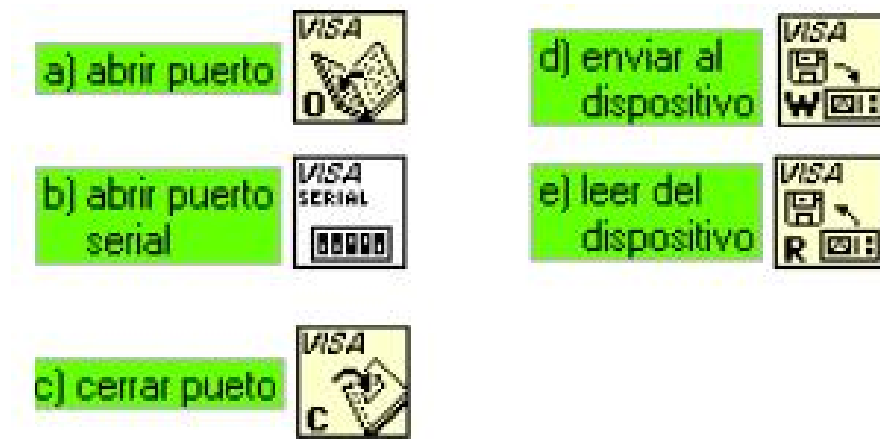
Figura 3.7: Secuencia lógica de operación del programa organizado para automatizar la técnica de Z-scan.
