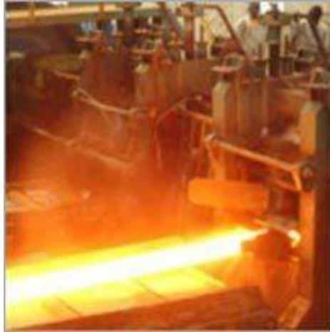
FIGURA 5.32 Laminación en caliente de perfiles estructurales
