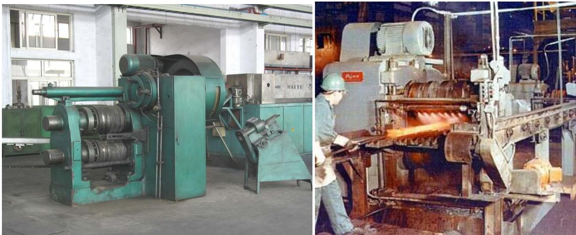
**FIGURA 4.7** Forja con rodillos
