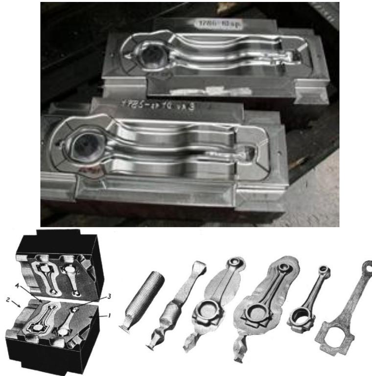
**FIGURA 4.6** Dados para Forja, dado progresivo para la fabricación de bielas
