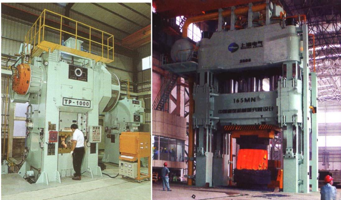
**FIGURA 4.13** Prensas para forja: (a) Mecánica, (b) Hidráulica
