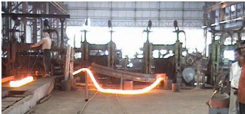
FIGURA 3.15 Se observa parte de un tren alineado o desplegado en el formador de lazo
