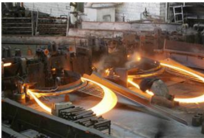
FIGURA 3.3 Procesos de deformación volumétrica. (a) laminación, (b) forja en matriz, (c) extrusión, (d) estirado, (e) formador de lazo durante la laminación de barras de refuerzo para construcción, (f) diferentes perfiles obtenidos por extrusión de aluminio
