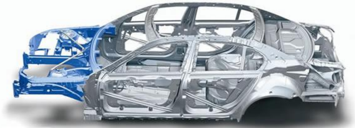
FIGURA 3.4 Los diferentes elementos que forman la carrocería de un automóvil se producen a partir de chapa metálica. Diseño híbrido de la carrocería, el frente (azul) corresponde a los componentes producidos en aluminio. Este diseño es utilizado por BMW en su serie 5 (fuente BMW)
