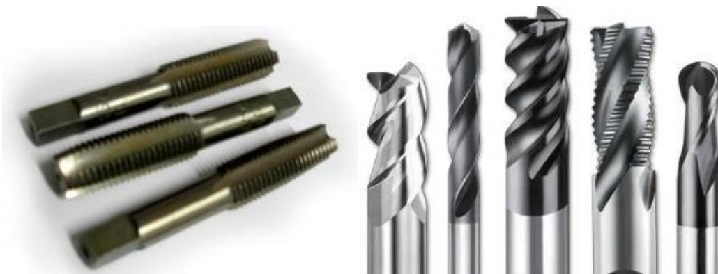
FIGURA 3.35 Diferentes tipos de herramientas enterizas (de un solo material); lado derecho machuelos de acero rápido, a la izquierda se presentan cortadores verticales de carburo de tungsteno
