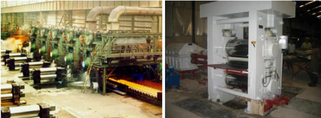
FIGURA 3.8 En la figura de la derecha se observa un tren de laminación en caliente, del lado izquierdo se tiene una laminador cuarto para operaciones de calibrado de espesor
