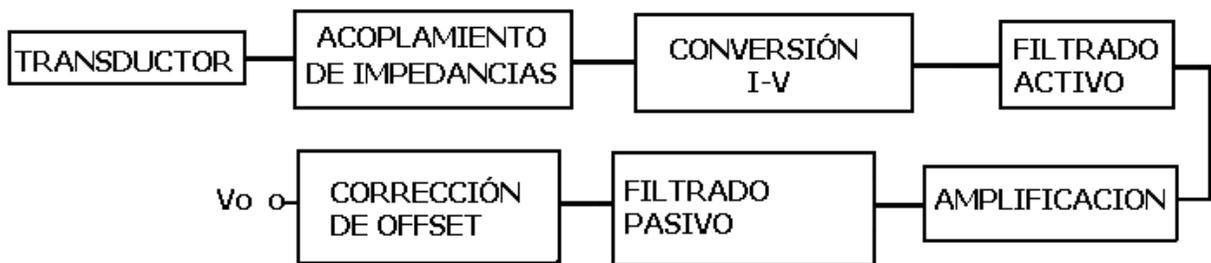
*Fig. 3.18. Etapas del acondicionamiento electrónico.*
