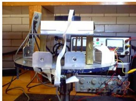
Fig. 5 En la imagen se muestra a los dos sistemas de sensado de movimientos angulares que trabajan al mismo tiempo bajo las mismas condiciones, esto nos da dos respuestas del mismo parámetro físico para hacer una comparación de los resultados.
