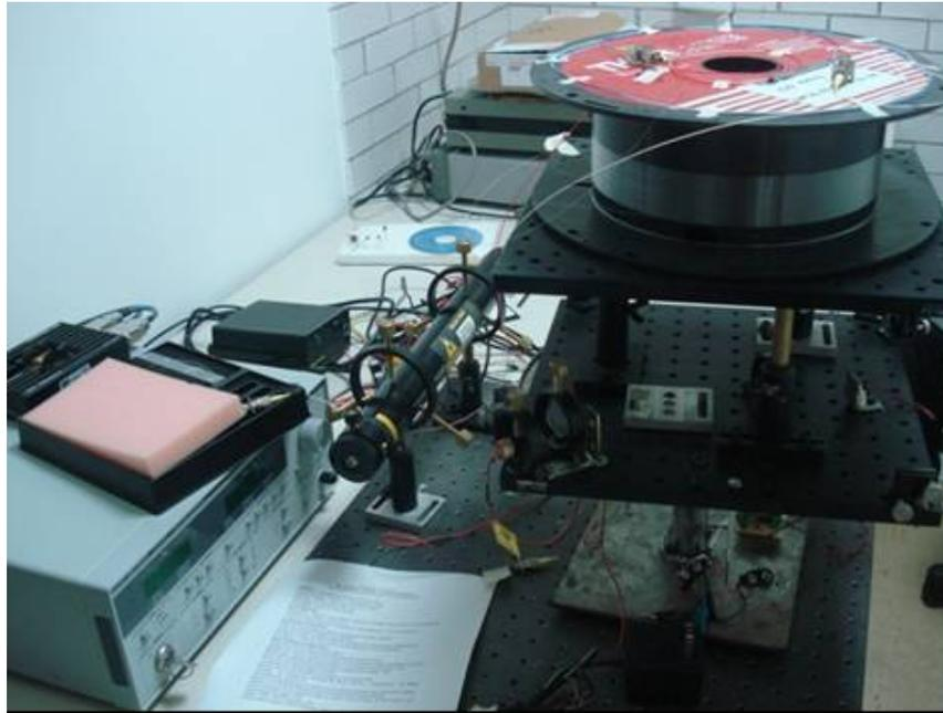
*Fig. 4.4 Fotografía del interferómetro de Sagnac en fibra óptica*
