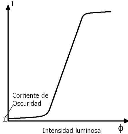
*Fig. 3.16 Curva del fotodetector en la región fotoconductiva de acuerdo al flujo de fotones*
