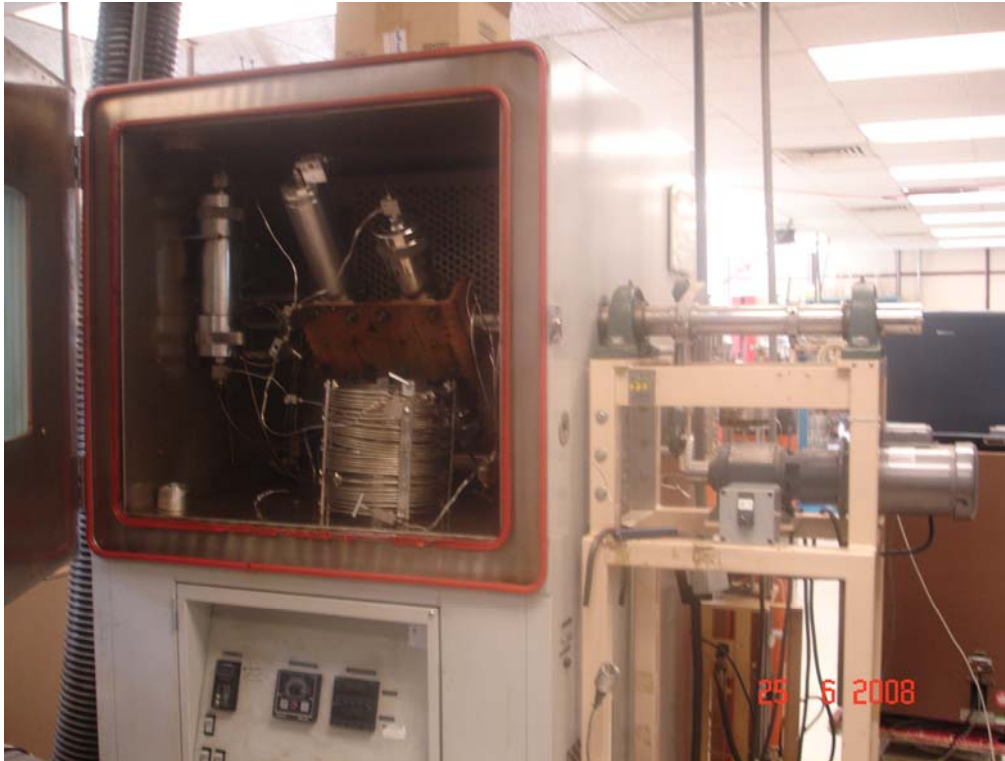
Fig. V.9 – Celda Bulk. Equipo utilizado para realizar pruebas de compatibilidad agitando muestras de fluidos a condiciones de presión y temperatura de yacimiento.
