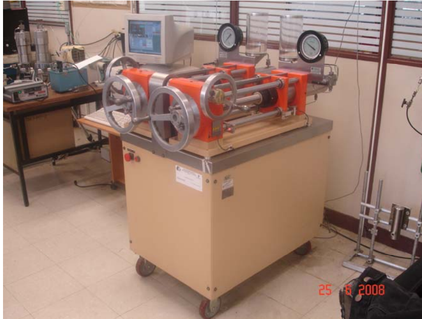
Fig. V.17 – Bomba de desplazamiento.
