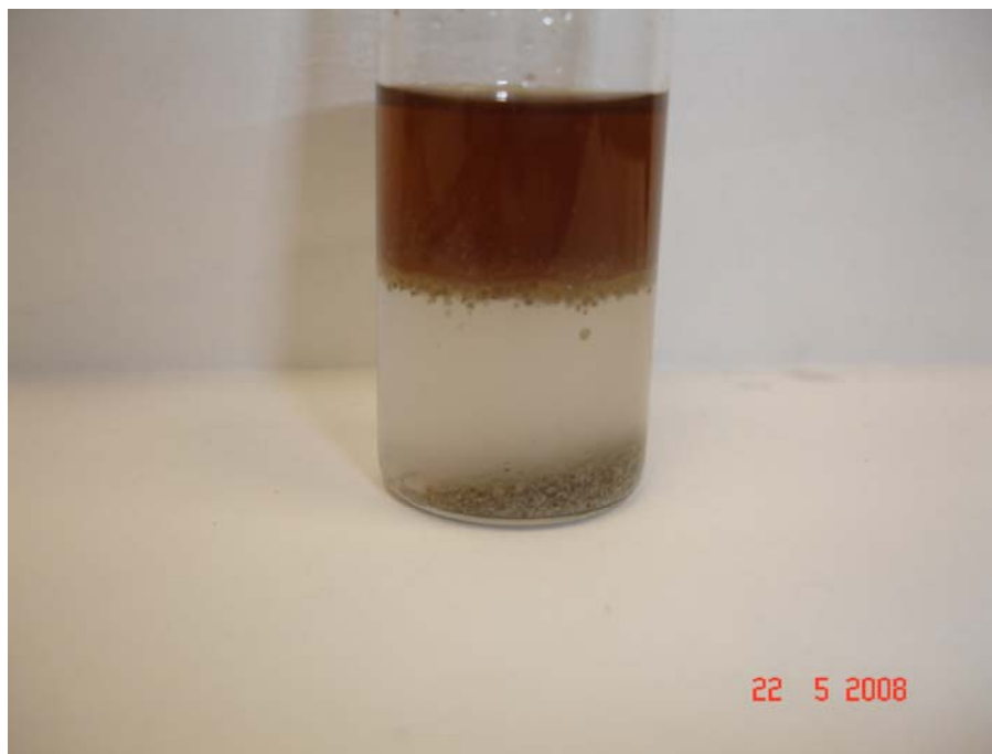
Fig. V.15 – Los granos de roca ya no muestran preferencia por el condensado.
