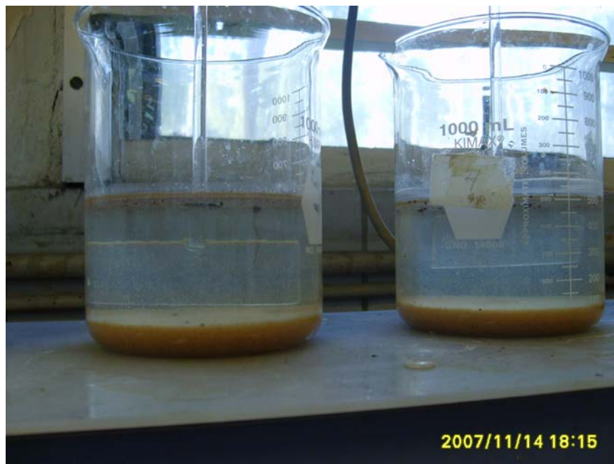
Figura 4.7 Color del agua al sedimentar los flóculos formados, después de aplicar el ferrato de potasio a las aguas congénitas.
