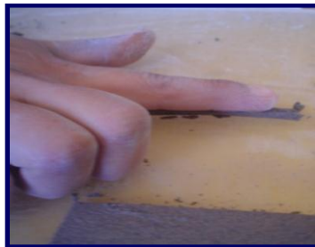
Figura 36. Formación de rollos de plasticidad (agregados CEMEX).
