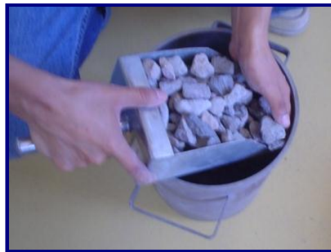
Figura 40. Llenado de la olla para masa volumétrica (agregados CEMEX).
