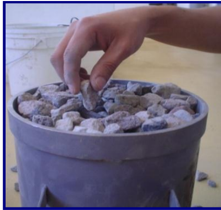
Figura 42. Enrasado manual para gravas (agregados CEMEX).
