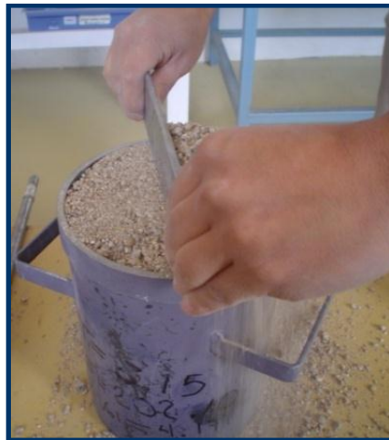
Figura 43. Enrasado de arenas (agregados CEMEX).
