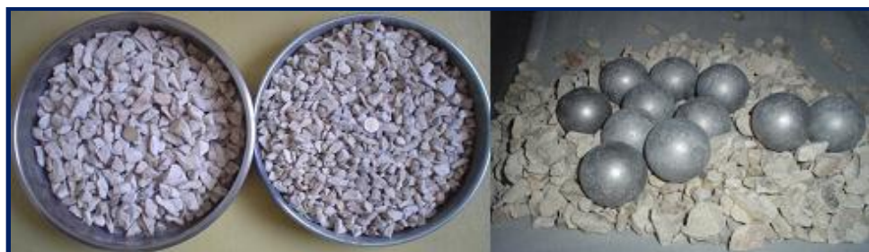
Figura 48. Muestras para la prueba y el interior del molino de bolas (agregados CEMEX).
