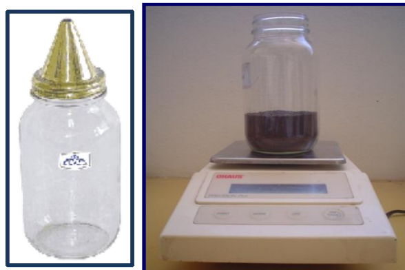
Figura 21. Picnómetro con material en estado SSS [34]
