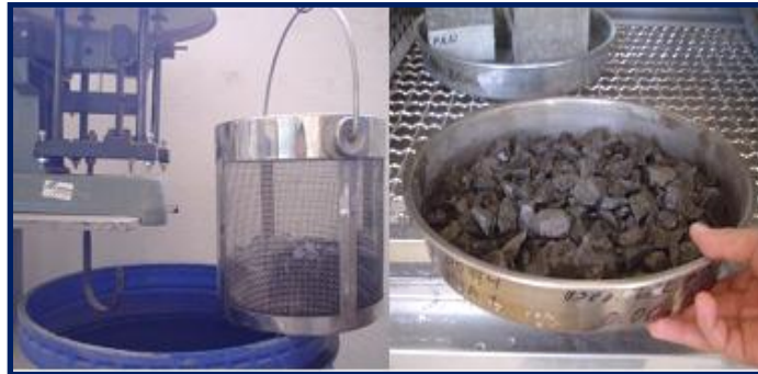
Figura 29. Muestra se lleva al horno para comprobar su absorción (agregados CEMEX).
