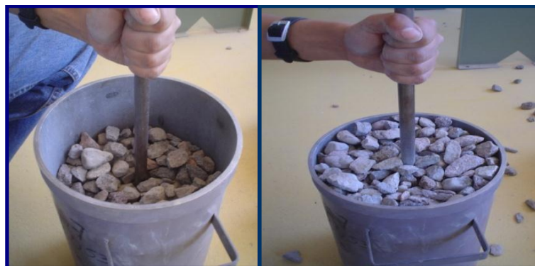
Figura 41. Compactaciones en segunda y tercera parte del recipiente (agregados CEMEX).
