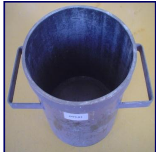
Recipiente cilíndrico para peso volumétrico con factor y tara conocidos con capacidad mínima de 14 litros
