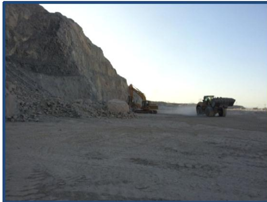
Figura 77. Cargador frontal rezagando el material producto de la voladura hacia las tolvas de la banda transportadora. Martillo hidráulico reduciendo rocas mal fragmentadas en la voladura
