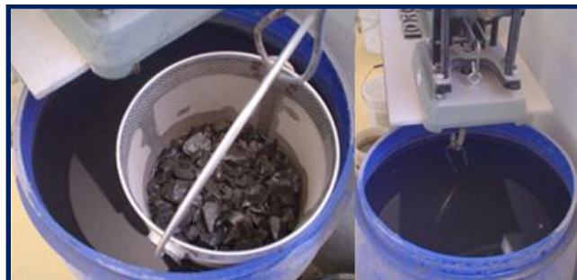
Figura 28. Muestra en estado SSS que se vuelve a saturar (agregados CEMEX).
