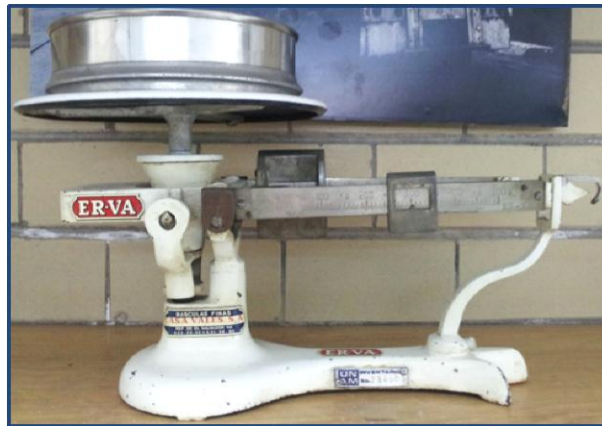
Figura 26. Tomando el peso de la muestra en estado SSS.
