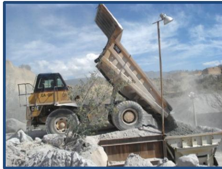
Figura 78. Camión con descarga trasera alimentando tolva.
