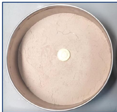
Figura 23. Muestra seca para determinar absorción del material y ejemplo de resultados.
