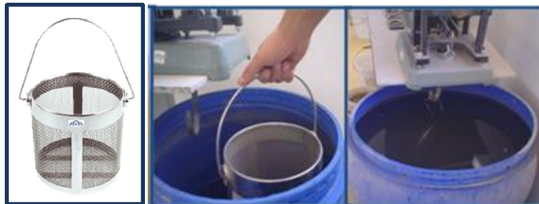
Figura 27. Canastilla sumergida para registrar su peso [34]
