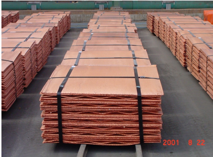
FIG. 8. FOTOGRAFÍA DEL PRODUCTO FINAL Cu, EL CUAL TIENE PUREZA DE 99.9%.
