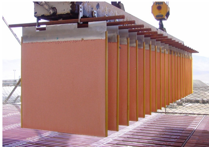
FIG. 7. FOTOGRAFÍA DEL TRANSPORTE DE CÁTODOS, QUE PROVIENEN DEL ÁREA DE LAVADO Y SE ENVÍAN A DECAPADO, FLEJADO Y APILADO.
