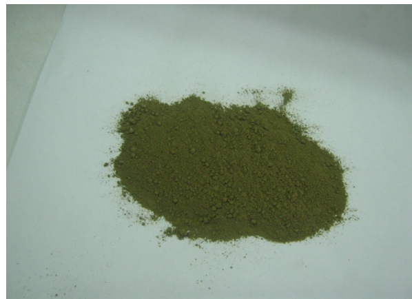
FIG. 13. FOTOGRAFÍA DE MUESTRA DEL MINERAL ÓXIDADO DE Cu PULVERIZADO, PARA GENERAR LA SOLUCIÓN RICA DE \text{Cu-(NH}_4)_2\text{SO}_4
