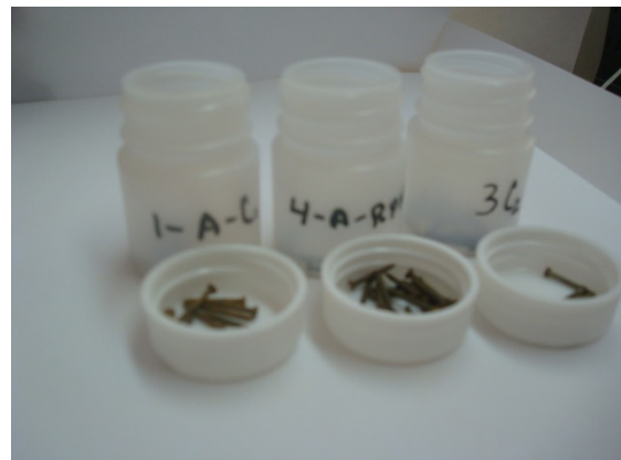
FIGURA 17. Fotografía del cementante una vez que se separó el Cu cementado.
