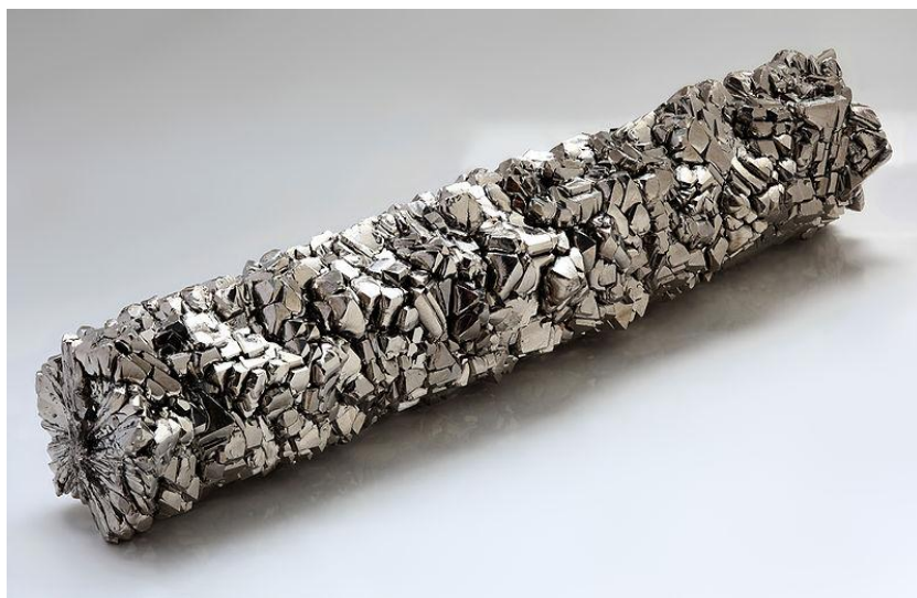
Figura 35: Barra de titanio cristalizado a través del proceso del yoduro
