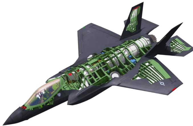
Figura 9: Estructura interna de un F35
