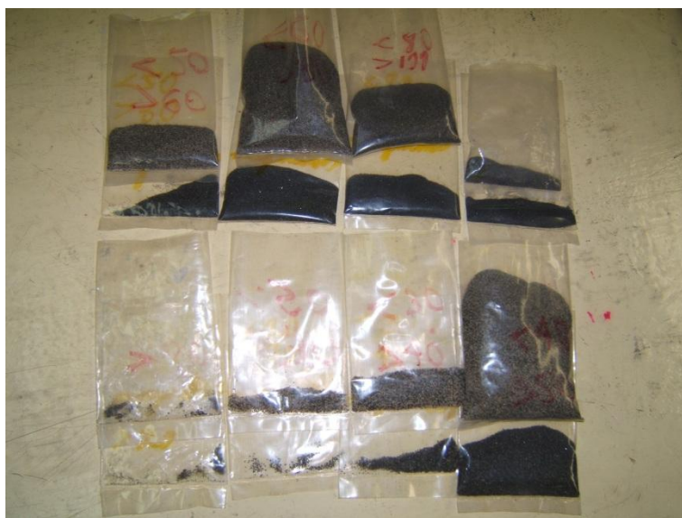
Figura 47: Arena agrupada en 8 rangos de tamaño de grano, las bolsas con arena oscura contiene los minerales magnéticos separados de las bolsas con la arena de varios colores, la bolsa con los granos magnéticos más gruesos se encuentra en la parte inferior izquierda, puede apreciarse que es una cantidad muy pequeña en comparación con las bolsas de granos de 40 a 50 mallas (extremo inferior derecho), 60 a 80 y 80 a 100 mallas (bolsas centrales de la fila superior), que son las bolsas con mayor contenido de arena; la arena más fina, menor a 100 mallas, se encuentra en la esquina superior derecha
