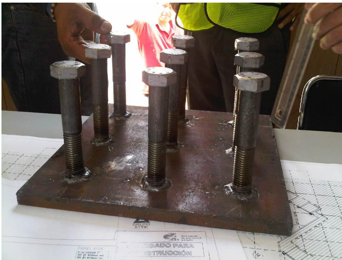
Figura 5.16. Placa de acero para muro de concreto.
