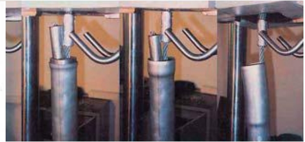
Figura 1.9 Sistema de frenado a base del ensanchamiento de un tubo de acero.
