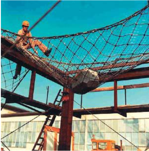
Figura 1.7 Primera prueba de barreras con uso de elementos de frenado.
