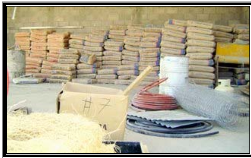
Figura 2.7. Papel proveniente de los sacos de cemento, para el reciclado de materiales para la construcción Fuente: http://images.google.com
