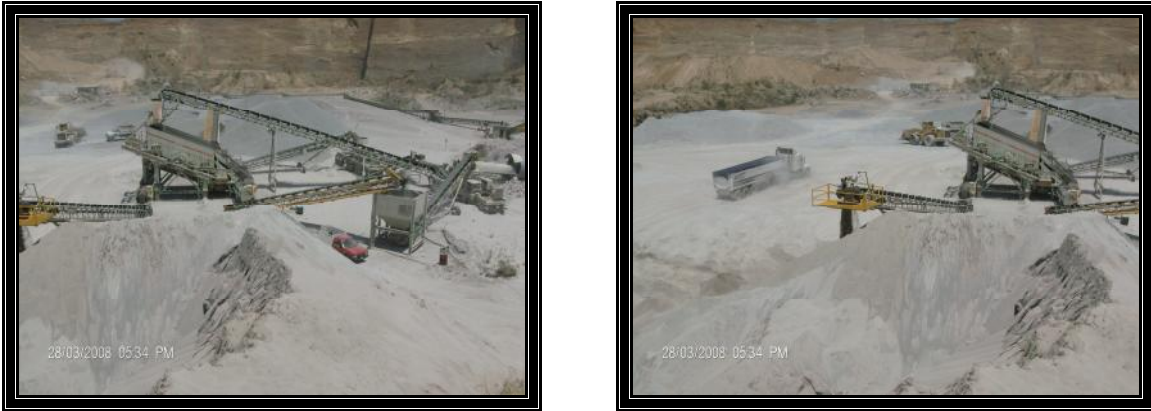
Figura 5.4. Trituración y clasificación de materiales para la industria de la construcción Fotógrafo: Guerry Martel Vargas
