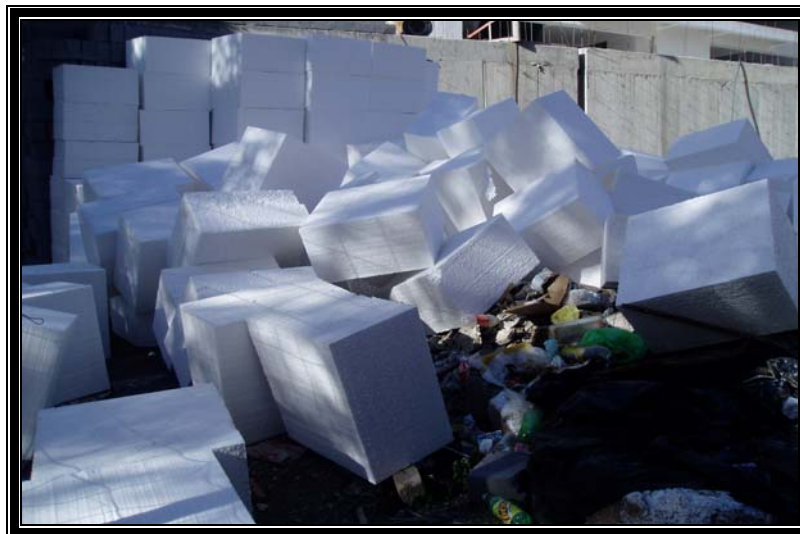
Figura 2.8. Plástico, PS (Poliestireno), para la construcción de losa aligerada Fuente: Elaborada por la autora
