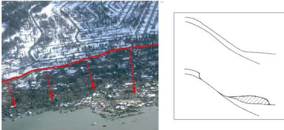
Fig 1. 2 Ejemplo Alaska (1964) y esquema de falla de flujo
