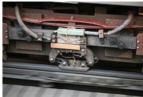
Figura 2.59. Frotador para alimentación por tercer riel.
