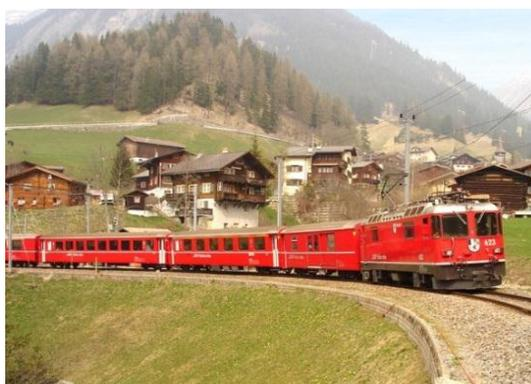
Figura 2.46. Tren de pasajeros que incorpora un furgón entre la locomotora y los coches de pasajeros.
