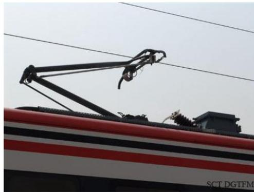
Figura 3.9. Pantógrafo del tren suburbano.
