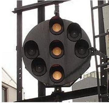
Figura 2.55. Señal mediante posición de luces.
