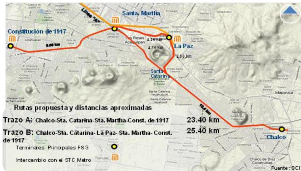
Figura 4.19. Trazos propuestos por la SCT para el trazo del Sistema 3.
