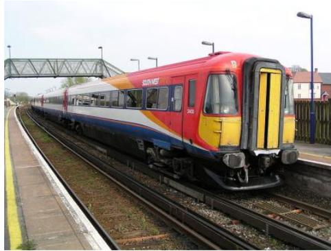
Figura 2.58. Tren de la serie 442 británica siendo alimentado por tercer riel.
