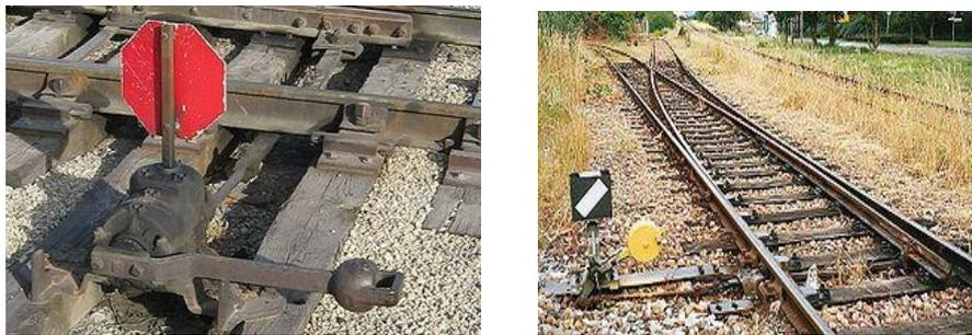
Figura 2.23. Palanca para cambios de vía de forma manual.
