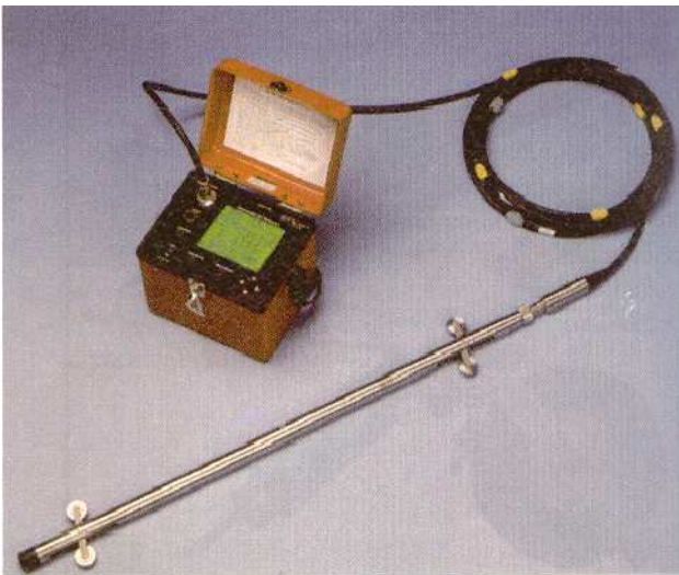
Imagen 38. Equipo de un inclinómetro. Los inclinómetros pueden ser de resistencia eléctrica, de cuerda vibrante y servoacelerómetros, alcanzando este último precisiones en la medida de giros de 2 \times 10^{-4} rad. Es importante asegurarse de que el inclinómetro se sitúa por debajo de la zona de posible movimiento.
