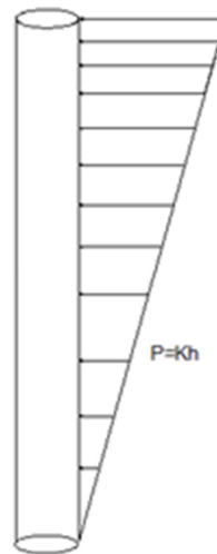
Figura 1.1.5 Efecto de viento en un poste
