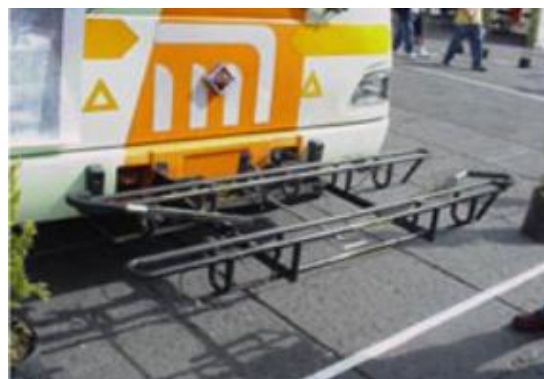
Figura 38 Autobús con rack para bicicletas
