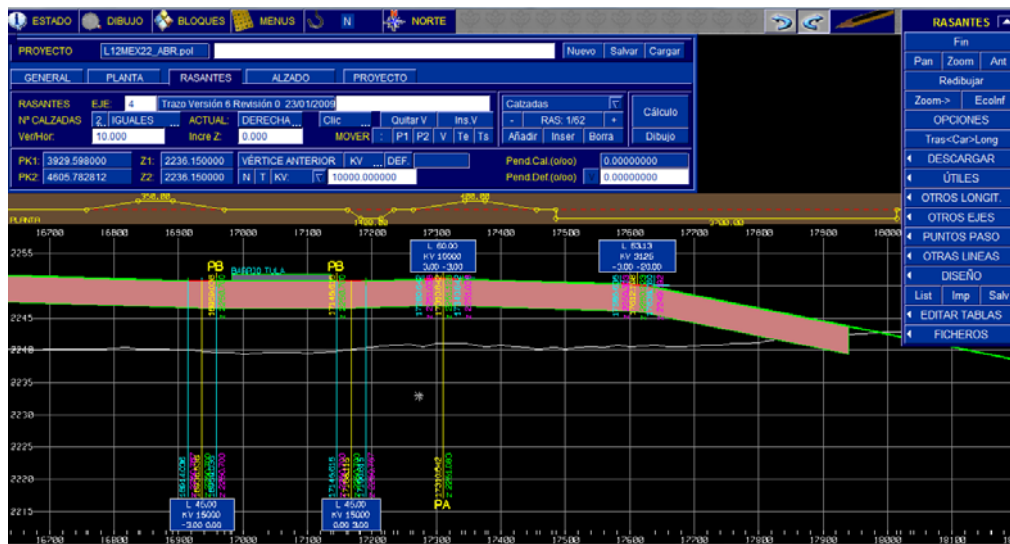
Impresión de pantalla: Muestra el galibo vertical libre en la zona de cambio de tramo elevado a cajón
