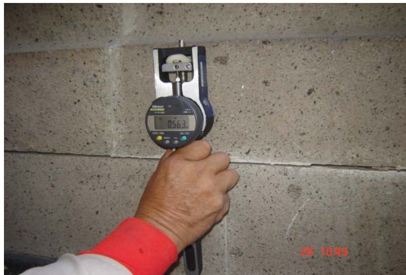
Fig. 5.9 a) Índices (puntos de referencia fijos), para la medición de la abertura de una junta horizontal entre dos hiladas consecutivas de sillares en una columna típica; b) lectura con extensómetro digital apoyado sobre dos índices.
