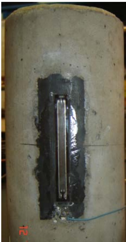
Fig. 3.30 Medición de deformaciones por galgas Extensométricas
