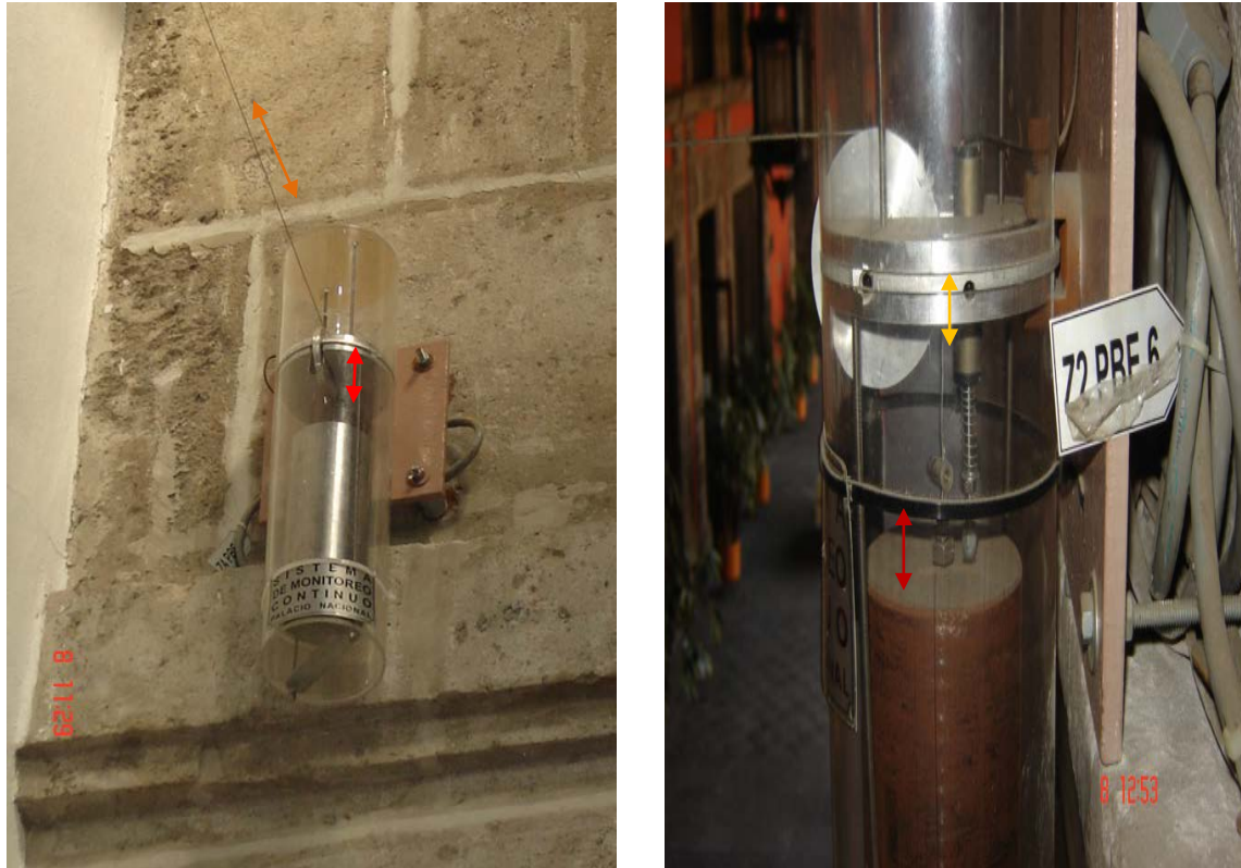
Fig. 5.6 Detalle de un extensómetro típico. Obsérvese que el cilindro de acero experimenta un movimiento vertical cuando la longitud del claro que mide se modifica. Esto se logra gracias a la presencia de una polea que cambia de dirección la trayectoria del tensor que se encuentra unido a ambos extremos del claro al que se da seguimiento. También se aprecia el sensor de desplazamiento lineal cuyo vástago móvil reacciona contra el cilindro.
