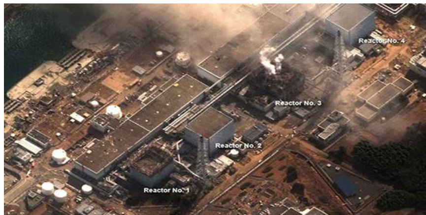
Fig.4.5 a) C. N. Fukushima: acumulación y explosión de hidrógeno del contenedor hacia el edificio del reactor (unidades 1, 2 y 3), dentro del contenedor primario (unidad 2), e incendio y explosión destrozando el techo del edificio (unidad 4); b) explosión en tres reactores de la c. n. Fukushima; c) Vista aérea del daño en el reactor 3 de la central nuclear (imágenes tomadas de la Ref. 14).
