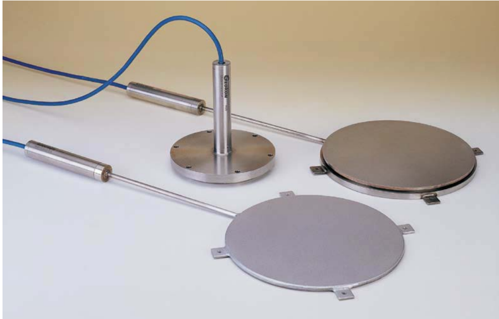
Fig. 3.37 Celdas de presión (Imagen tomada de la empresa ENSESA, S. A. DE C. V.).
