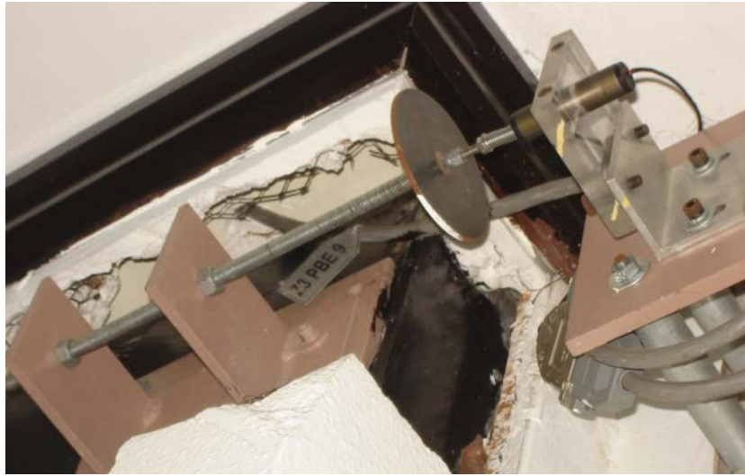
Fig. 3.33 Extensómetro típico. En la imagen se aprecia la terminal del sensor de desplazamiento lineal que reacciona con el movimiento horizontal de la placa circular de acero.
