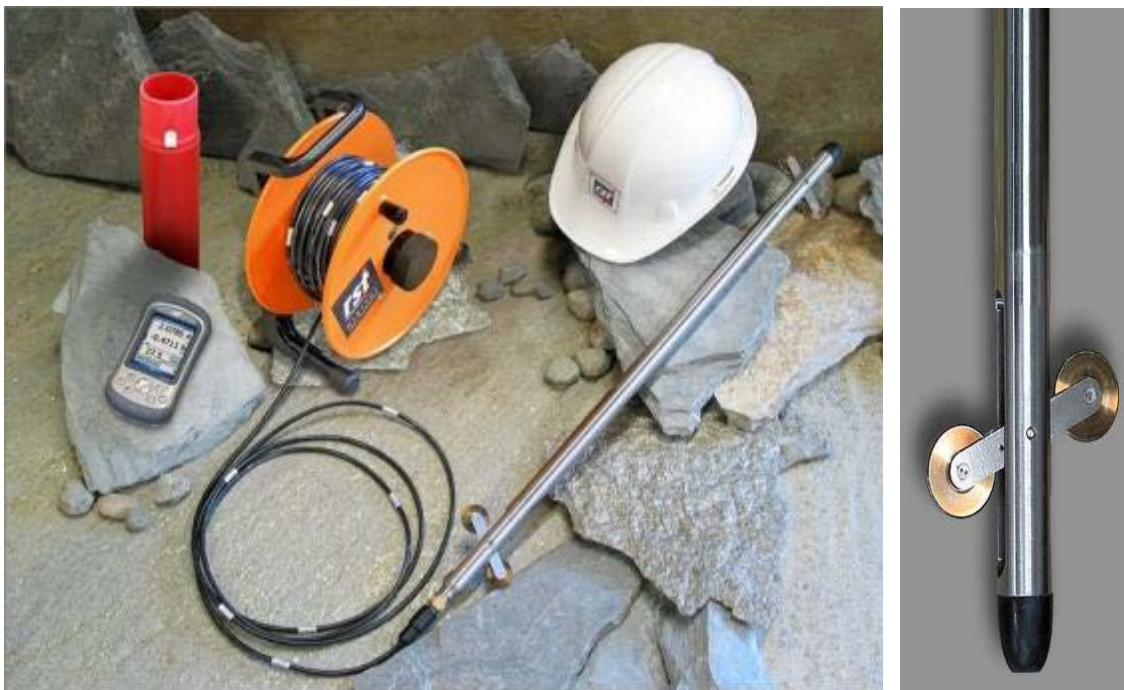
Fig.3.28 Inclinómetro de aplicación geotécnica, para medición de desplazamientos horizontales (imágenes tomadas de la Ref.22).
