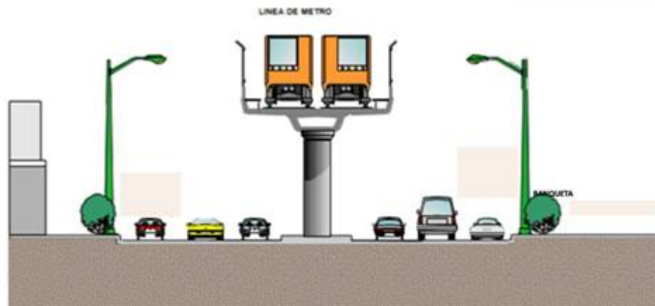
Sección terminada del viaducto elevado
