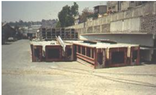
Molde autotensable de acero (trabe doble T)
