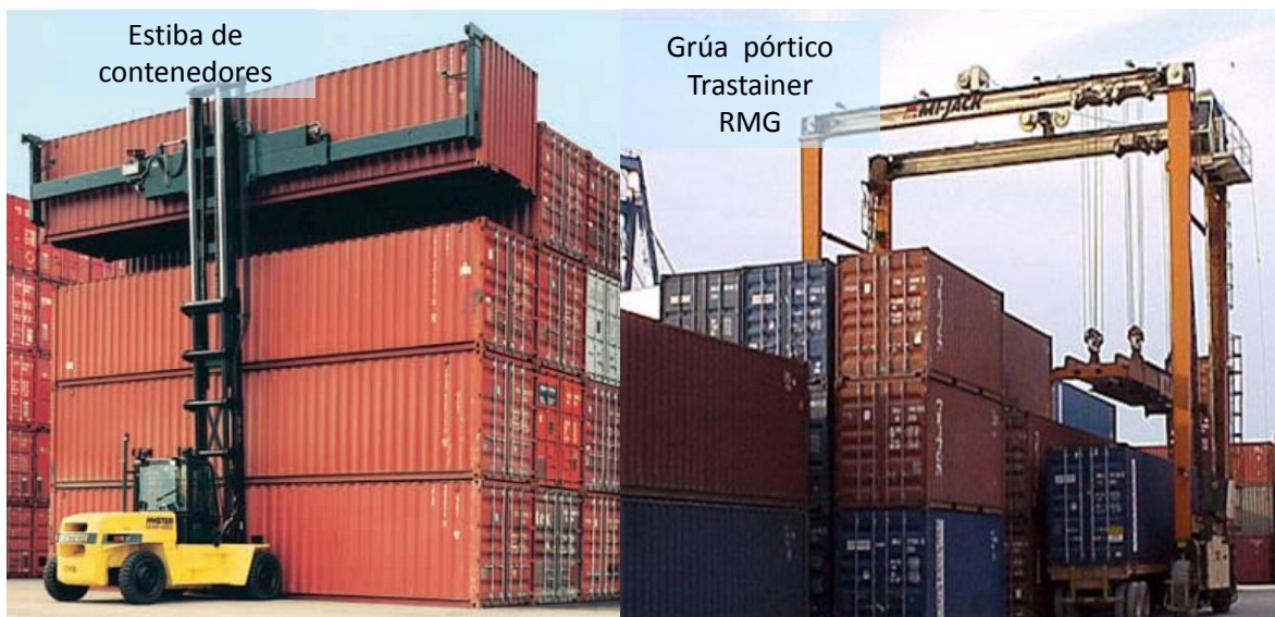
Figura 17. IZQUIERDA. Estiba de contenedores realizada por una grúa tipo Bombcart side-handler . DERECHA. Grúas de pórtico tipo trastainer 26 . Elaboración propia con fotos tomadas en el Puerto de Lázaro Cárdenas.
