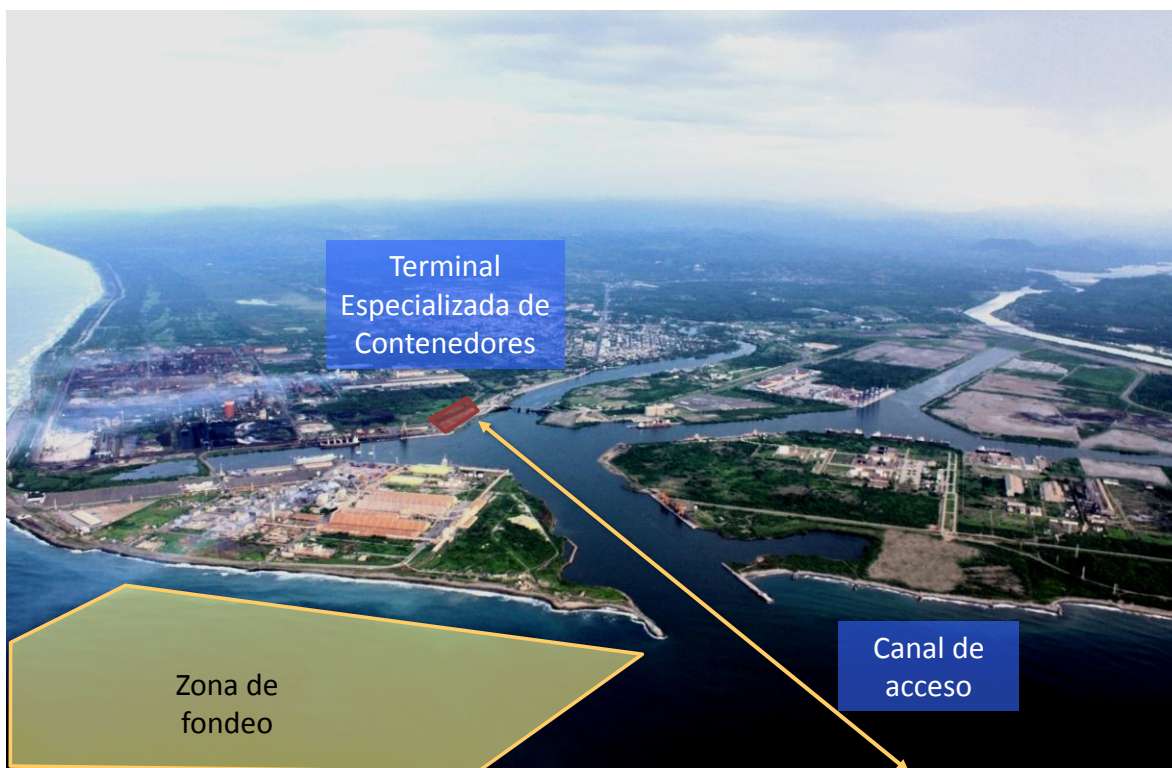
Figura 12. Ejemplo de la distribución de la zona de fondeo y canal de acceso a la terminal portuaria para el Puerto de Lázaro Cárdenas. Elaboración propia. Foto tomada del documento “Programa Maestro de Desarrollo del Puerto de Lázaro Cárdenas 2011-2016”, API Lázaro Cárdenas S.A. de C.V.
