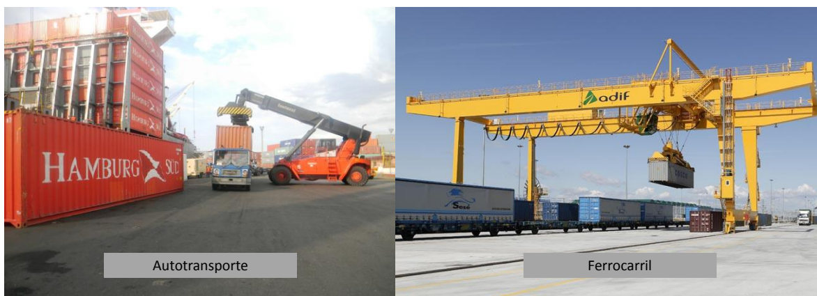
Figura 19. IZQUIERDA. Recolección de un contenedor realizado por una grúa tipo Bombcart top-handler . DERECHA. Grúas de pórtico tipo trastainer 28 . Elaboración propia con fotos tomadas en el Puerto de Lázaro Cárdenas.
