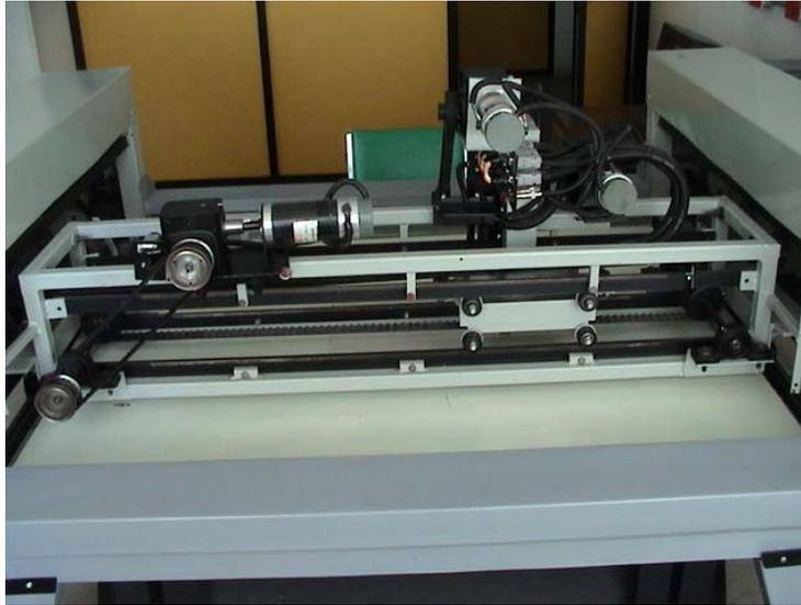
Figura 1.8 Algunos elementos del prototipo de robot cartesiano
