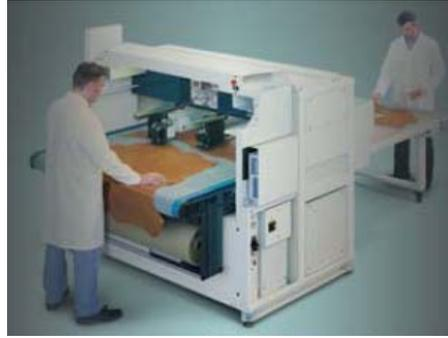
Figura 1.5 Máquina de corte por cuchilla CM44
