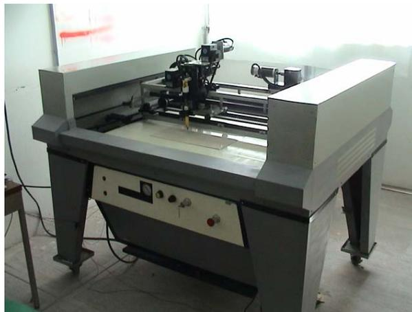
Figura 1.7 Prototipo de robot cartesiano para corte de cuero
