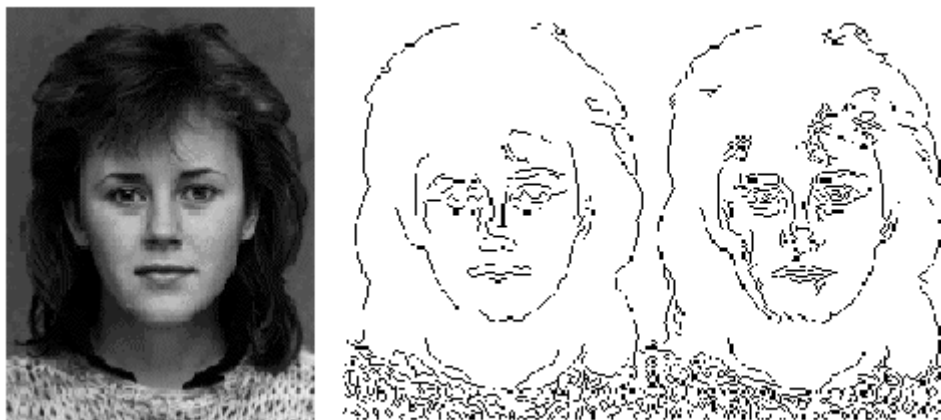
Figura 2.9. Resultados obtenidos por el operador de Canny utilizando diferentes umbrales de corte en el proceso de histéresis.
