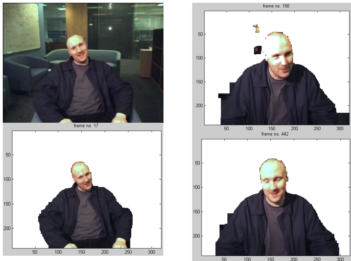
Figura 5.5. Secuencia 3 (JM). Trama del video y resultados de la segmentación de video (trama 17, 158 y 442).
