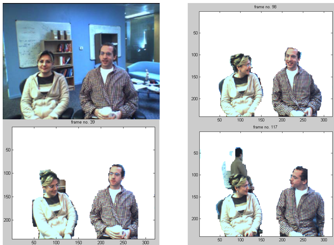
Figura 5.8. Secuencia 6 (IUJW). Trama de la secuencia del video a segmentar y resultados de la segmentación de dos capas (tramas 39, 98 y 117).
