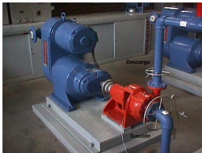
Figura 4.2. Instalación de la bomba de flujo mixto. Rango de operación de 820 a 3280 rpm, potencia 15 HP.
