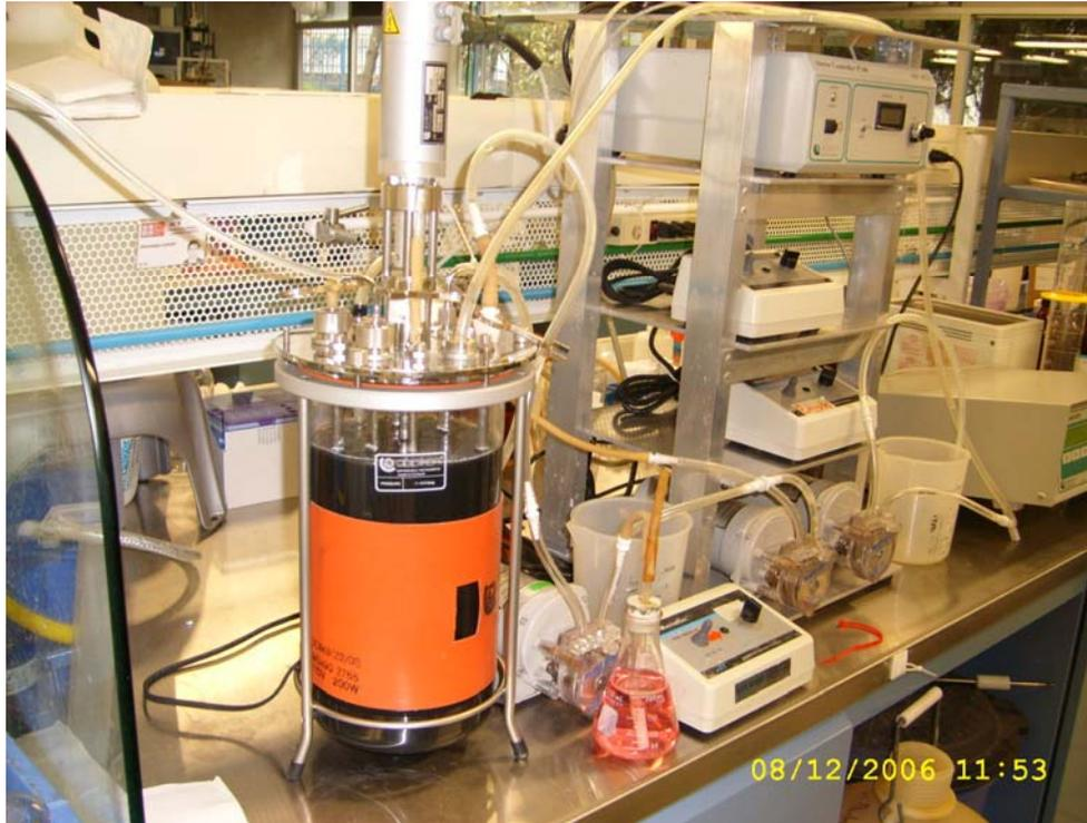
Figura 5.3. Reactor sulfato-reductor biomasa suspendida.
