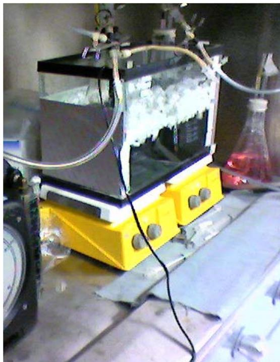
Figura 5.2. Reactor para la aclimatación sulfato-reductor y sulfuro-oxidante.
