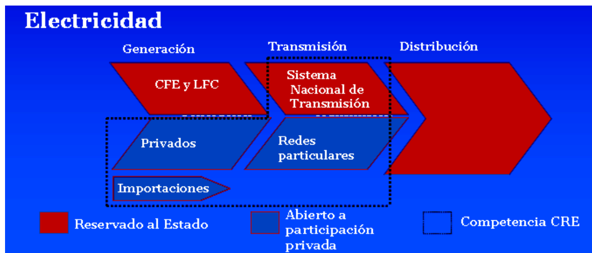
Figura 2.7 Estructura del sistema eléctrico nacional.
