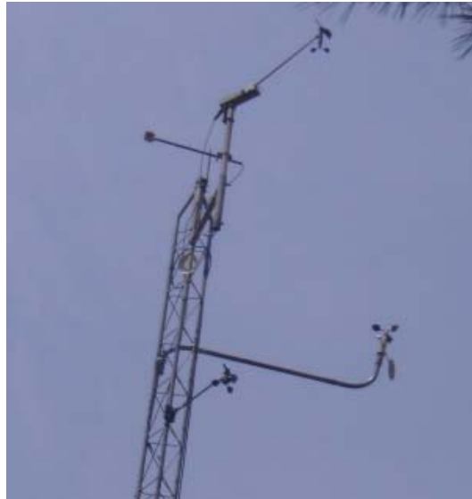
Figura 4.18. Copas de Robinson del Observatorio de la UNAM
