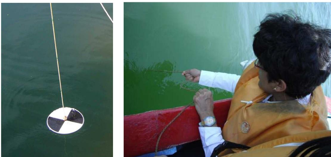
**FIGURA 5.9 DETERMINACIÓN DE LA TURBIEDAD POR MEDIO DEL DISCO DE SECCHI**
