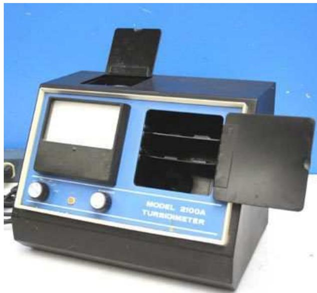
**FIGURA 5.14 TURBIDÍMETRO CON EL QUE SE REALIZÓ LA DETERMINACIÓN DE TURBIEDAD**
