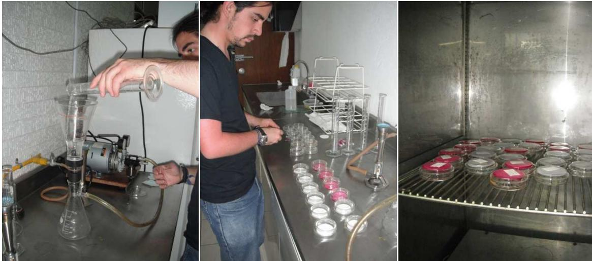
**FIGURA 5.11 APLICACIÓN DEL MÉTODO DEL FILTRO DE MEMBRANA**
