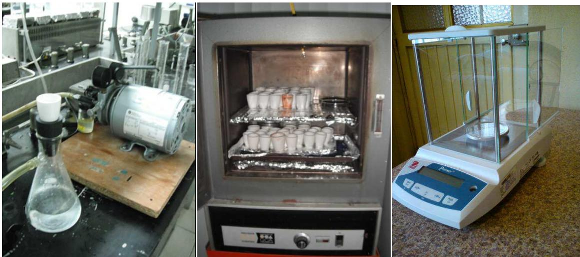
**FIGURA 5.13 DETERMINACIÓN DE LOS SÓLIDOS SUSPENDIDOS TOTALES**
