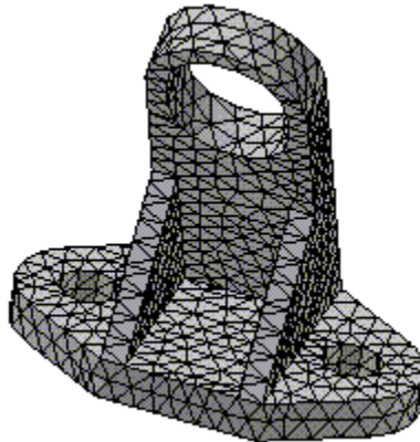
Fig. 1.16 Ejemplo de una malla de un modelo de pieza mecánica
