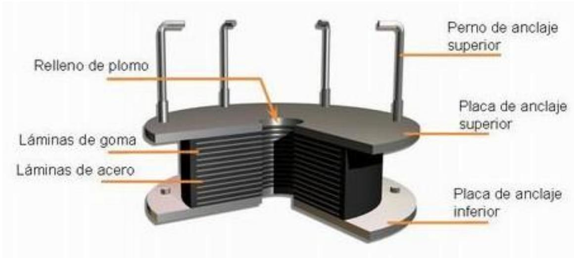
*Figura 3.17: Corte esquemático de un aislador de base.*
