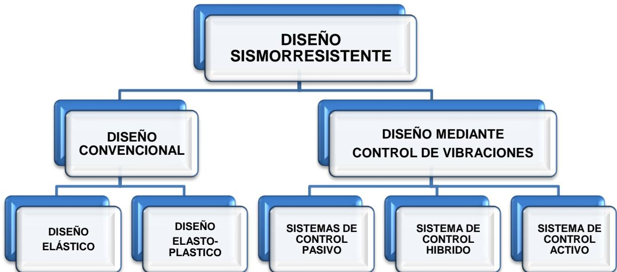
*Clasificación del Diseño Sismorresistente.*
