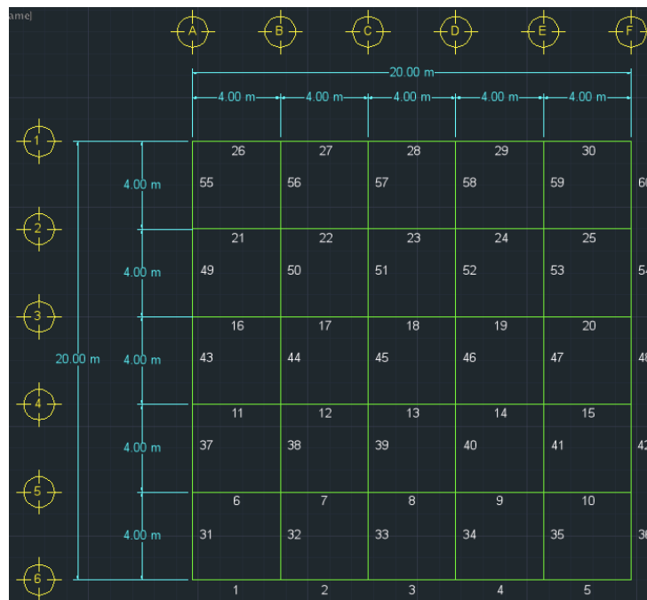
Figura 4. Numeración de barras en cimentación.
