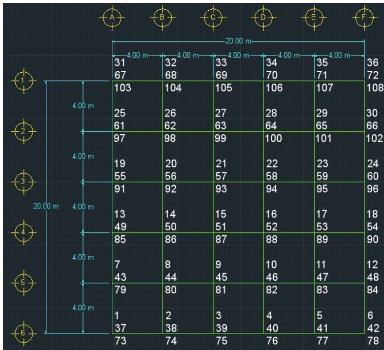
Figura 3. Numeración de grados de libertad.
