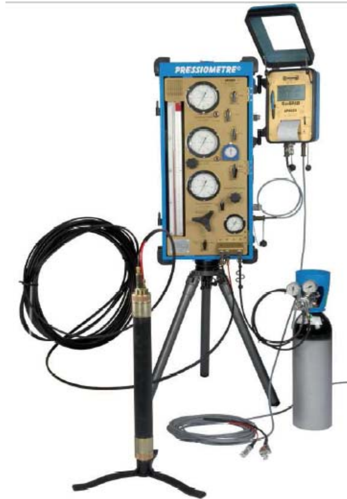
Figura 4.- Equipo requerido para ejecución de ensayos con el Presiómetro Menard.
