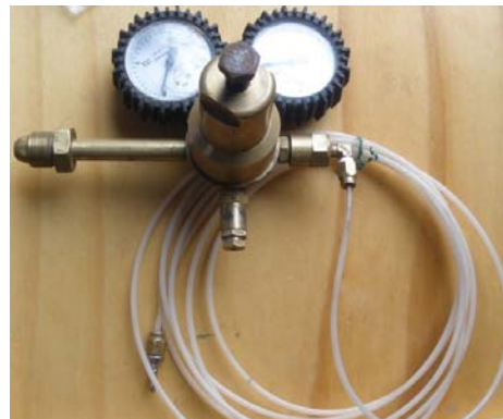
Figura 13.- Regulador con dos manómetros
