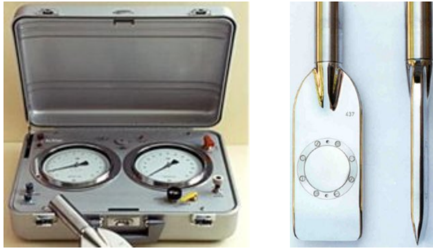
Figura 7.- Equipo principal utilizado en ensayos con Dilatómetro Marchetti.
