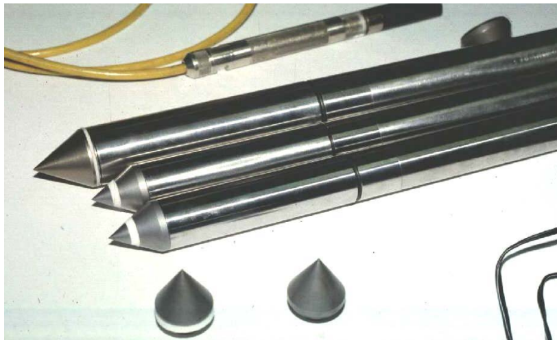
Figura 5.- Piezocono tipo ENVI Memocone.
