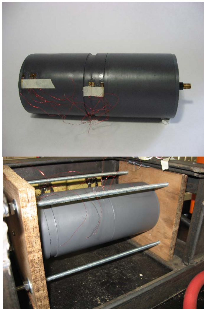
Figura 3.10 Arreglo para la prueba de presión en juntas tipo espiga-campana de PVC.
