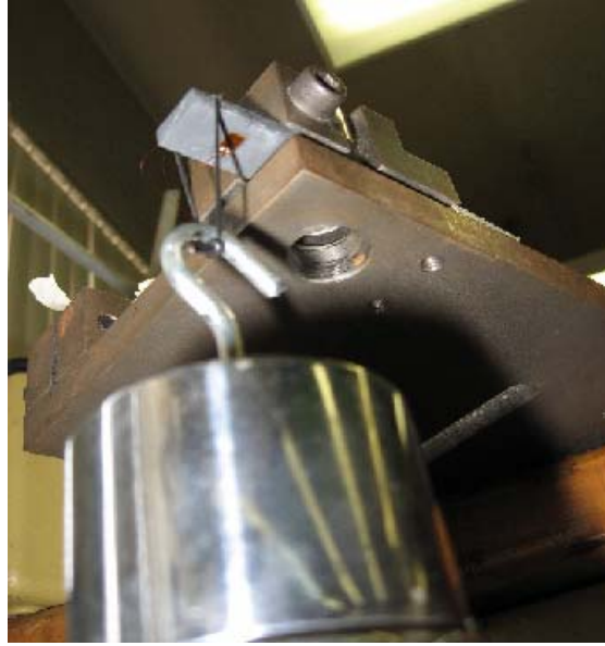
Figura 3.3 Probeta F1-PVC sometida a flexión en arreglo en cantilever
