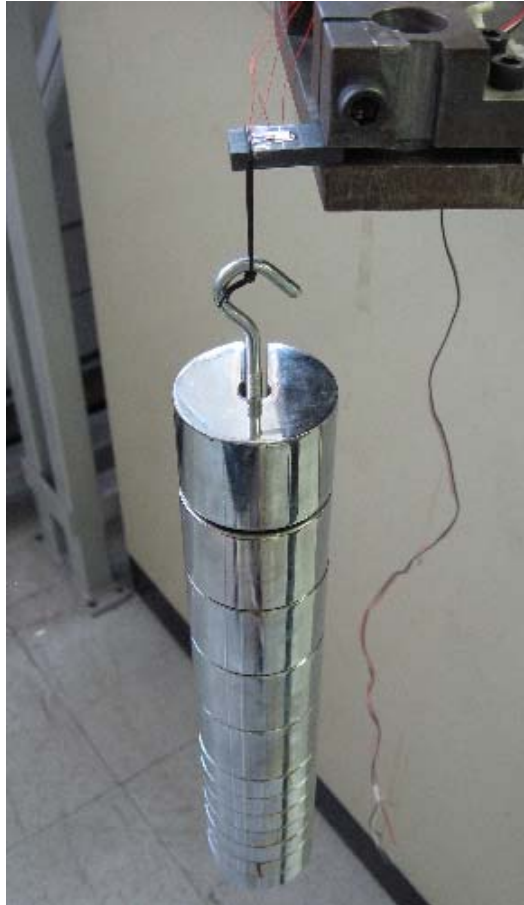
Figura 3.2 Probeta F1-PVC sometida a flexión en arreglo en cantilever
