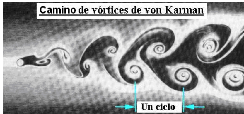
Figura 1.3 Vórtices de Von Karman generados en un tanque de laboratorio, el flujo va de izquierda a derecha
