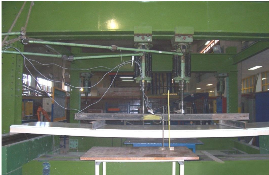
Figura 2-10. Desarrollo del ensaye para los paneles probados en el Laboratorio de Materiales del Departamento de Estructuras.
