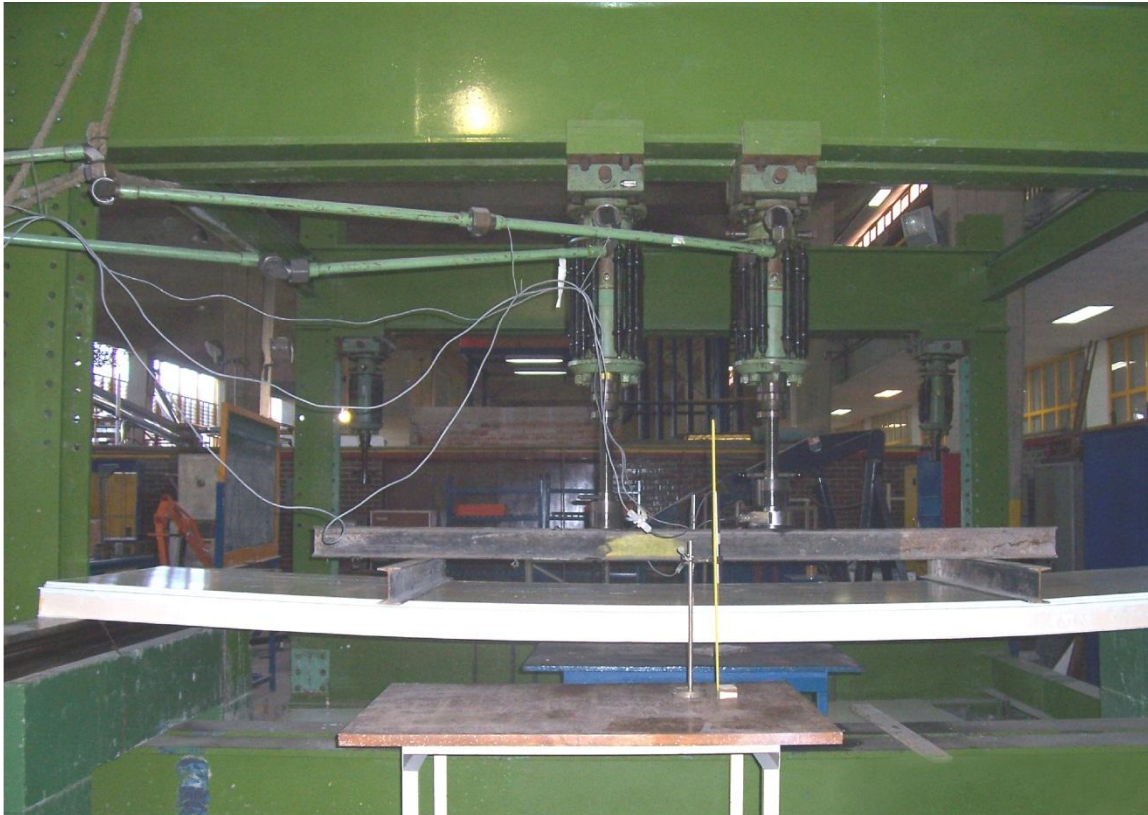
Figura 3-2. Pruebas a los paneles “Metecno”, en el marco de carga del Laboratorio de Materiales de la F.I.
