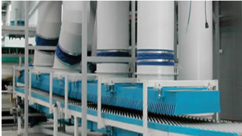
Figura 2.4 Quench. Sistema de enfriado a presión.
