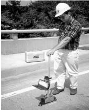
Fig.II.6.- Operación del Dipstick (Fuente: Asociación Española de la carretera).
