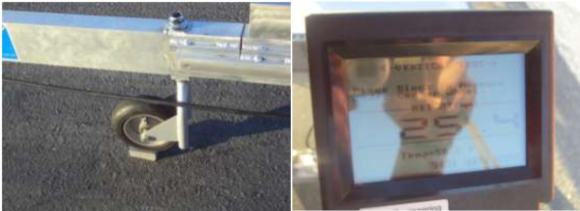
Fig.IV.3.- Imagen que muestra la comprobación de los 25.4 mm o 1” de la calibración vertical del Perfilógrafo (Fuente: Fotografías propias).
