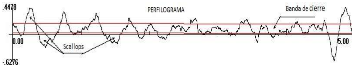
Fig.II.14.- Perfilograma (Fuente : Normativa N-CSV-CAR.3.02.005/06, SCT ).
