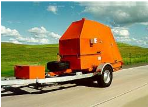
Fig. I.10.- Falling Weight Deflectometer (Fuente: Kuab).
