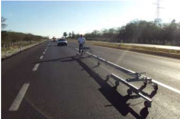
Fig. II.8.- Perfilógrafo tipo California (Fuente: Fotografía propia tomada en la carretera Campeche-Mérida).
