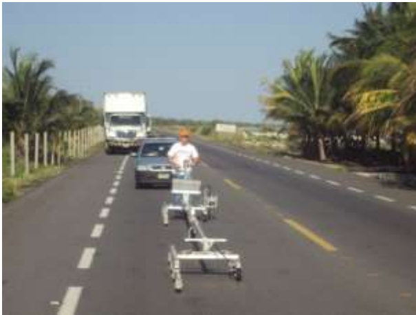
Fig. II.14.- Perfilógrafo tipo california, midiendo el Perfil (Fotografía Propia en la carretera Cd del Carmen-Campeche).
