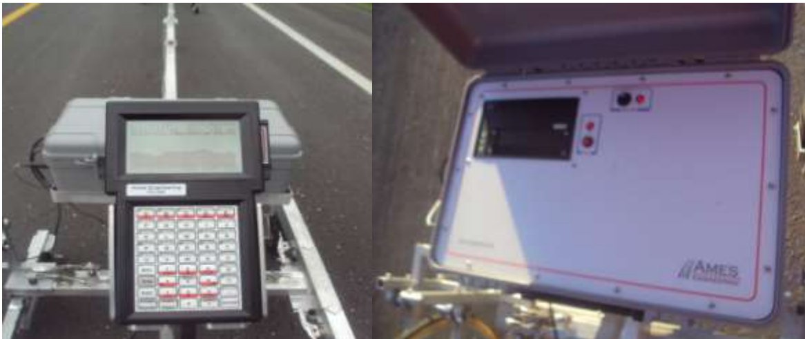
Fig. IV.2.- Unidades de proceso del perfilógrafo California Marca Ames (Fuente: Fotografías propias, tomadas en el sitio de la realización de los trabajos).
