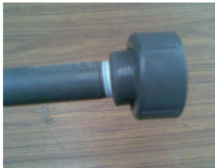
Figura 35: Ensamble de tuberías y accesorios
